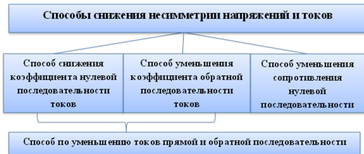
Рисунок 1 – Способы снижения несимметрии напряжений, токов и K_p
