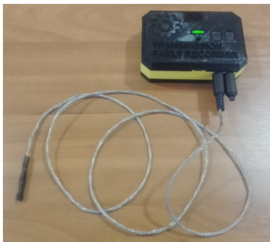
Рисунок 2 – Цифровой регистратор с датчиком для автоматической коррективы с учетом температуры окружающей среды
