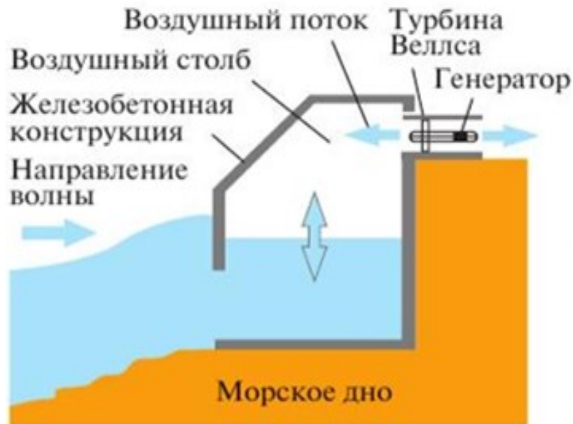
Рисунок 1 – Вариант конструкции приливной электростанции с использованием турбины
