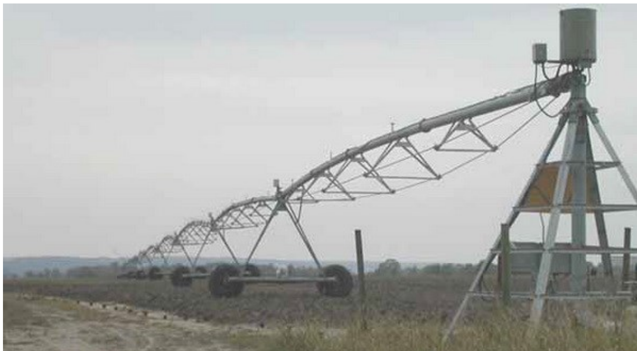
Рисунок 1 – Общий вид дождевальной машины с гидроприводом «Фрегат-П»
