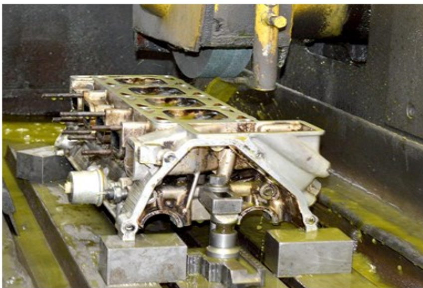
Рисунок 4 – Ремонт ГБЦ (шлифовка) трактор Д 240-245
