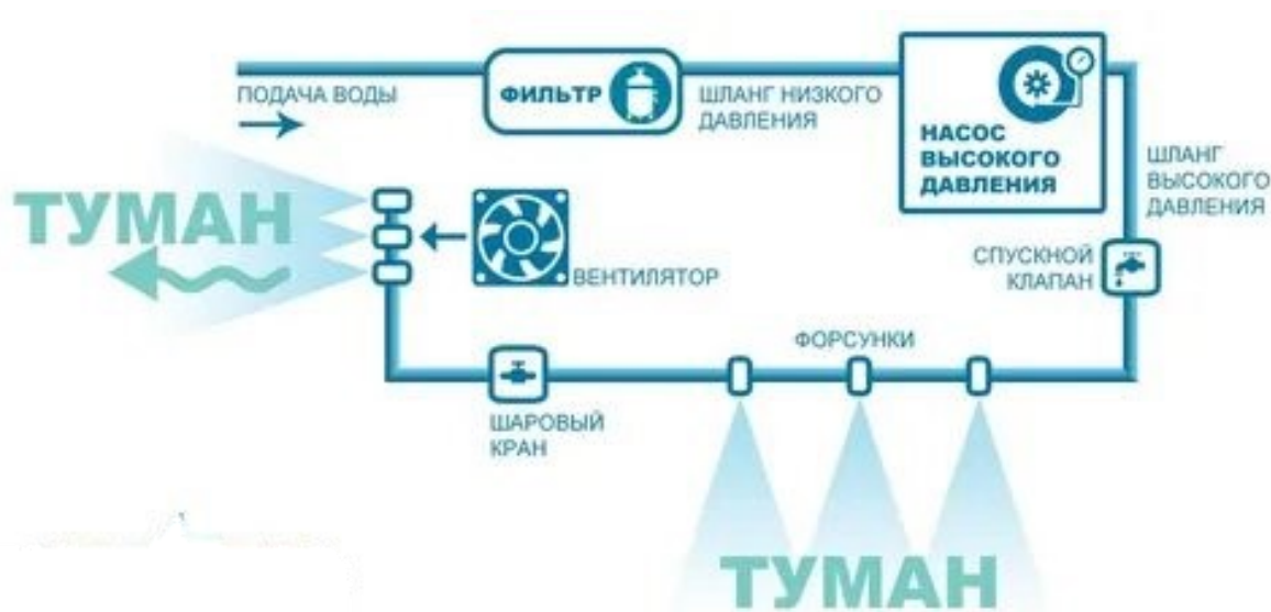
Рисунок 2 – Пример туманообразующей установки
