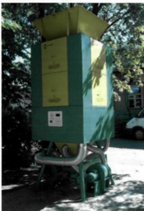
Рисунок 1 – Микроволновая электроустановка предпосевной сушки зернового материала АСТ-3
