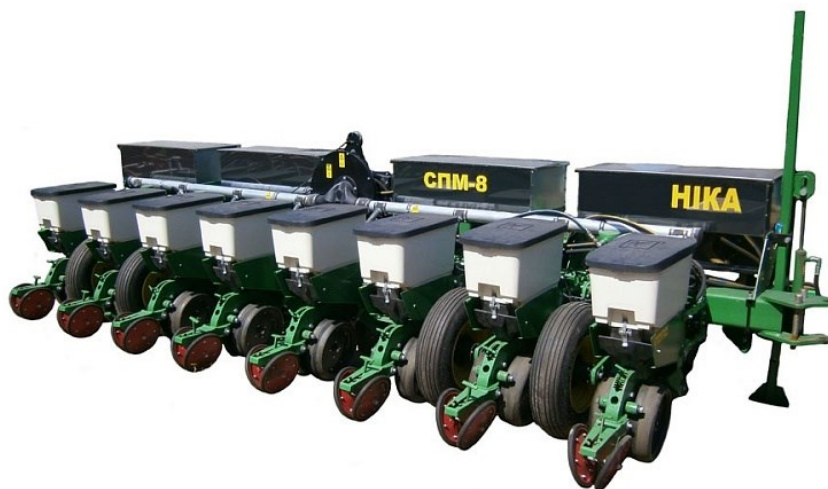
Рисунок 5 – Сеялка с системами точного высева
