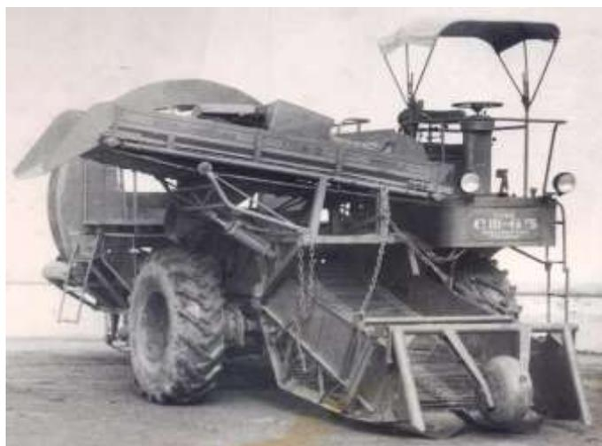
Рисунок 1 – Двухрядный картофелеуборочный комбайн ККСШ-2, навешиваемый на самоходное шасси СШ-65 (СССР)
