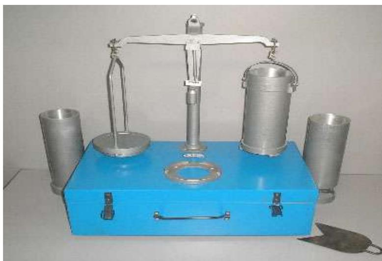
Рисунок 1 – Общий вид лабораторной установки для определения объёмной массы смеси отжатой мезги и кукурузного экстракта.
