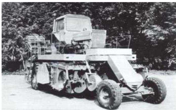
Рисунок 2 – Четырехрядный картофелеуборочный комбайн КСКД-4 на базе трактора МТЗ-142 (СССР)
