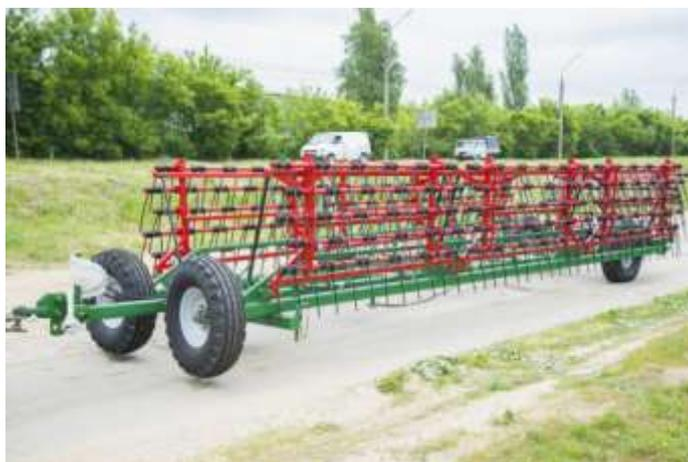
Рисунок 6 – Борона пружинная
