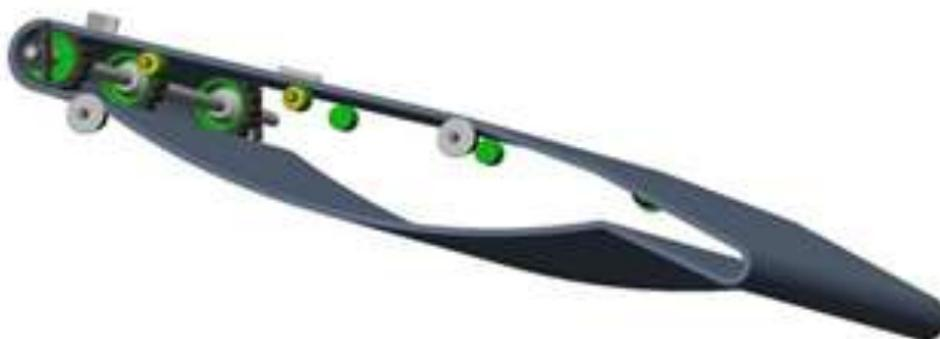
Рисунок 3 – Приемный транспортер под двойной гребень
