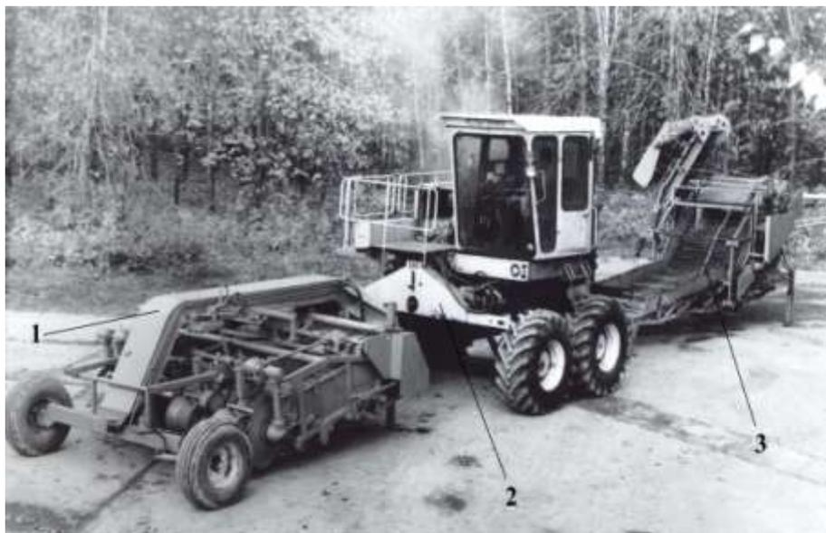
Рисунок 5 – Самоходный четырехрядный блочно-модульный картофелеуборочный комбайн БМСК-4К (Россия) во время уборки картофеля:
