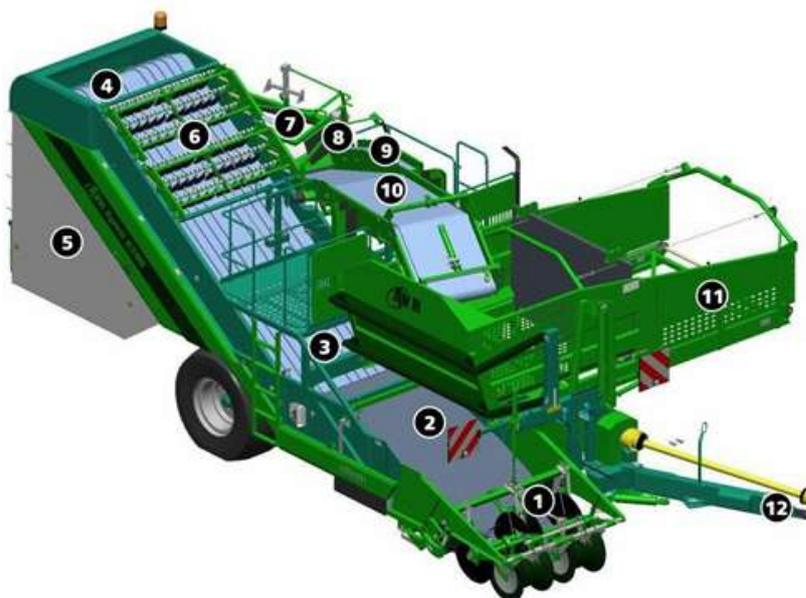
1-подкапывающая секция; 2-приемный транспортер; 3-просеивающий транспортер; 4-ботвоотводящий транспортер; 5-ежный транспортер; 6-ботвозадерживающие ролики; 7-поперечный ежный транспортер+роторная гребенка или опция; 8-ботвозадерживающие ролики; 9-транспортер для отвода примесей; 10-инспекционный стол; 11-бункер; 12-дышло
