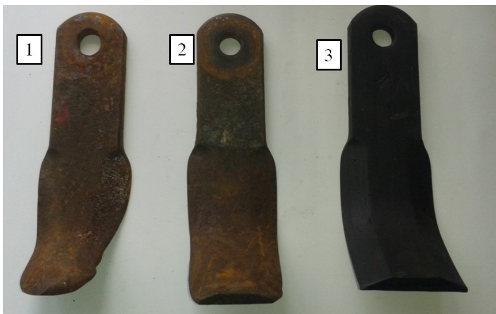
Рисунок 1 – Ножи измельчающего аппарата: 1 – износ 60%; 2 – износ 43%; 3 – износ 0% (новый)
