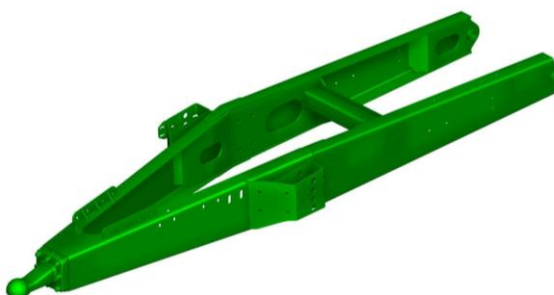
Рисунок 2 – Открытое дышло модели JoskinTrans-CAP
