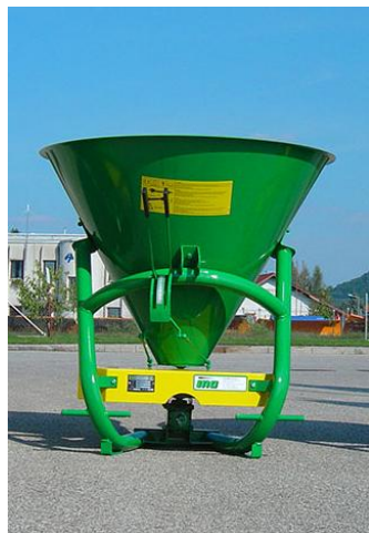
Рисунок 3 – Общий вид и технологическая схема разбрасывателя МВУ–0,5А:
