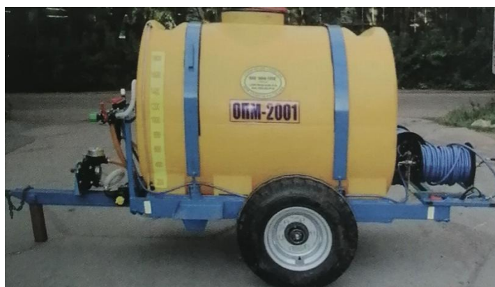
Рисунок 5 – Машина для дезинфекции животноводческих помещений и зерноскладов МДП-2006
