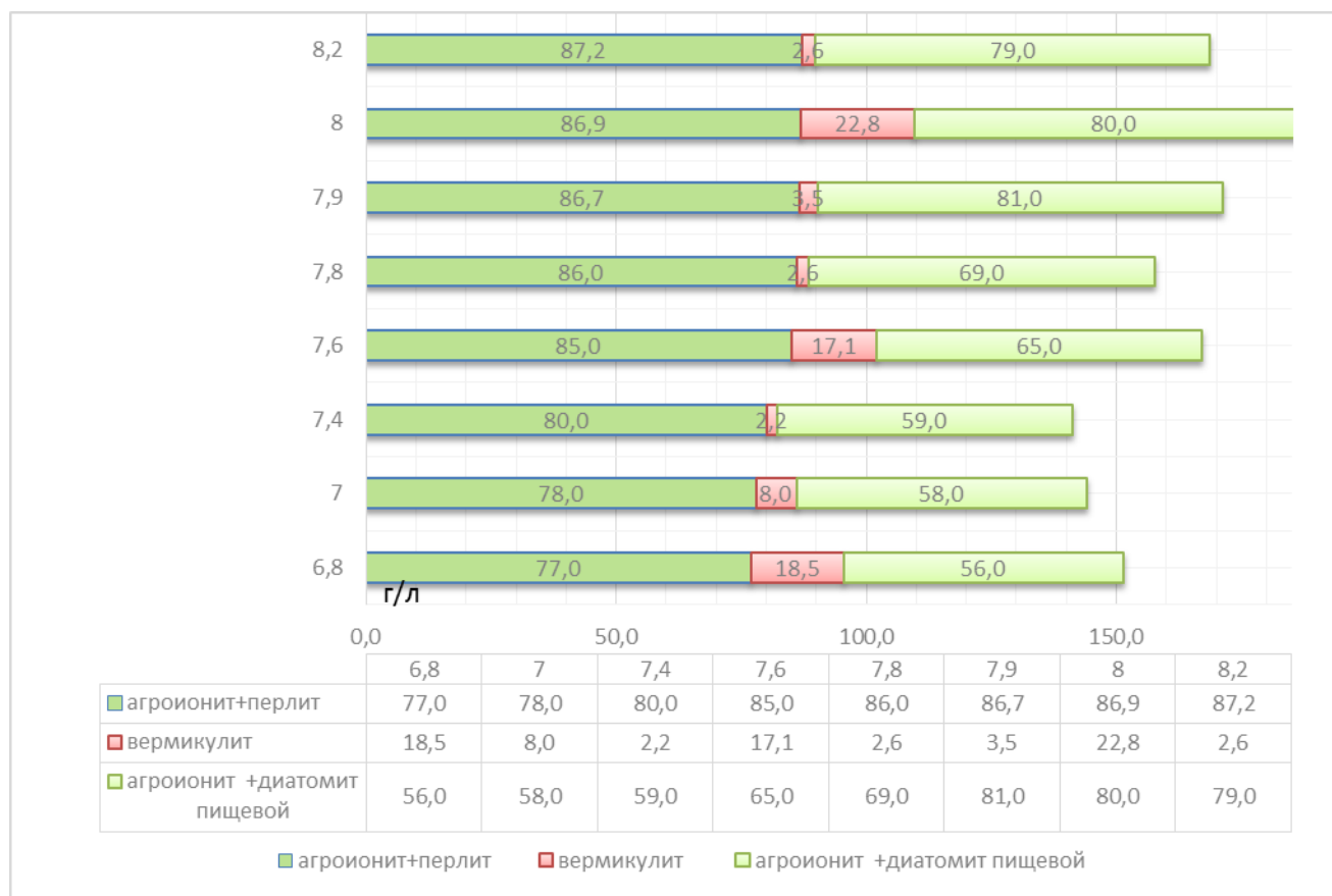
Рисунок 3 – Эффективность сорбционного процесса при исходной минерализации воды 7 г/л
