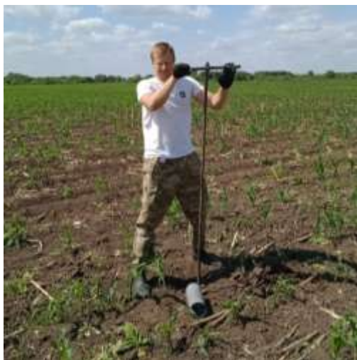
Рисунки 2 – Бурение и обустройство наблюдательных скважин на участке стационарных наблюдений (июнь 2023 года)
