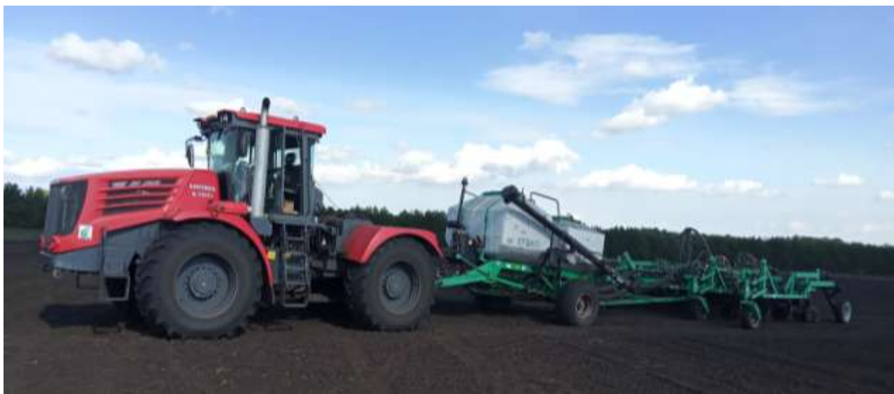
Рисунок 1 – Определение тягово-энергетических показателей колесного трактора К 735 с посевным комплексом ПК 6.1 на посевах
