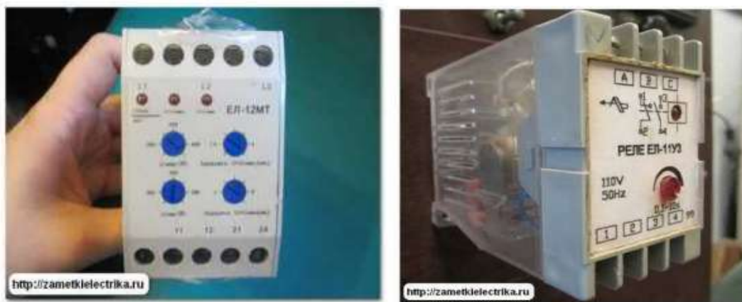
Рисунок 1 – Реле ЕЛ-11, ЕЛ-12, ЕЛ-13
