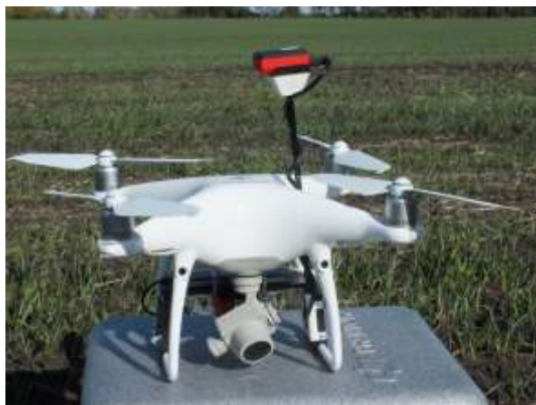
Рисунок 1 – БПЛА DJI Phantom с мультиспектральной камерой Parrot Sequoia
