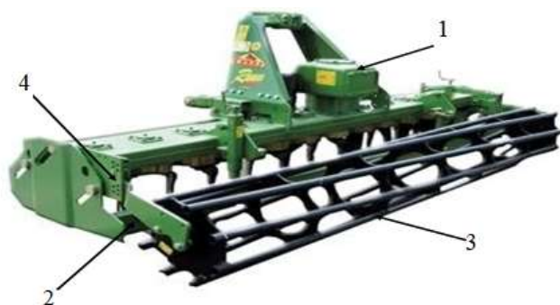
Рисунок 2 – Вертикально-фрезерный культиватор Celli Ranger 300 предназначенный для обработки почвы и одновременного предпосевного прикатывания
