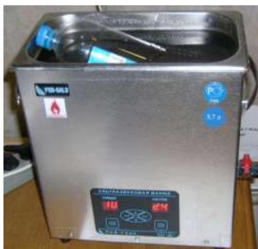
Рисунок 1 – Установка для ультразвуковой обработки УДП железа
