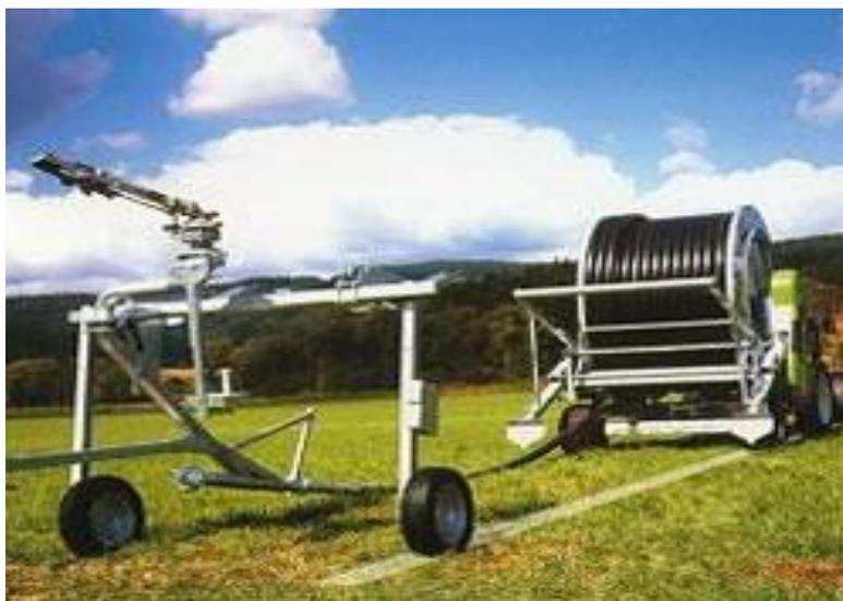
Рисунок 5 – Барабанная дождевальная машина
