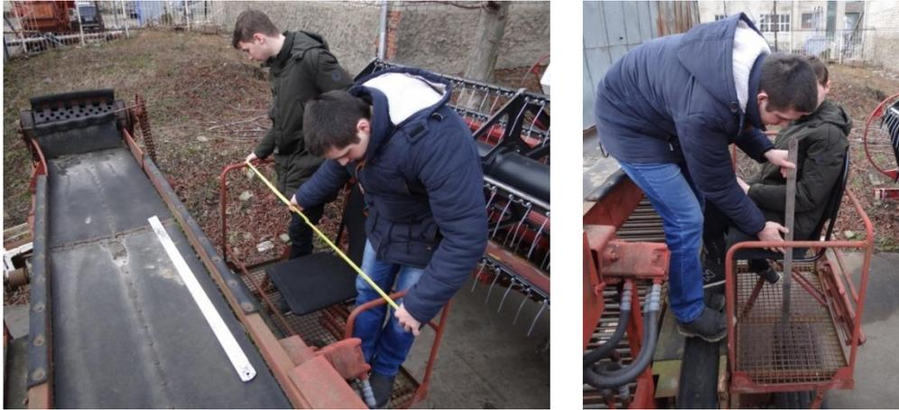
Рисунок 2 – Определение параметров площадки и сиденья
