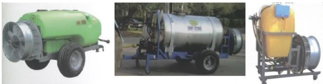
Рисунок 3 – Вентиляторные опрыскиватели ОВГ-2005, ОВГ-2200 (с баком из нержавеющей стали) и ОВГ-600 соответственно.
