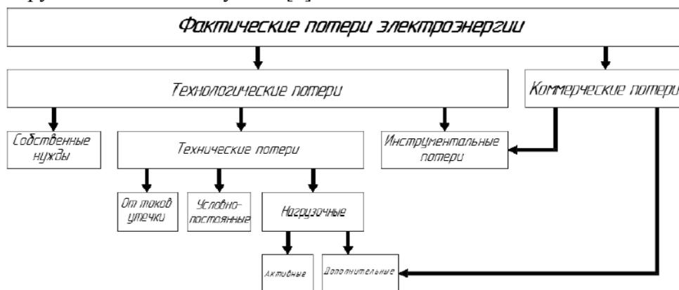
Рисунок 3 – Классификация потерь электроэнергии в сети 0,38 кВ
