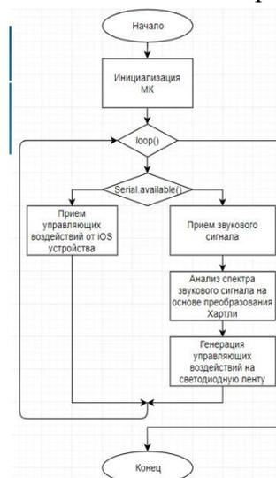
Рисунок 4 – Упрощённая блок-схема программной части МК
