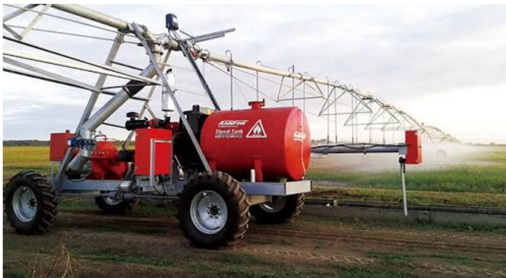
Рисунок 1 – Мобильная (перемещаемая) дождевальная машина
