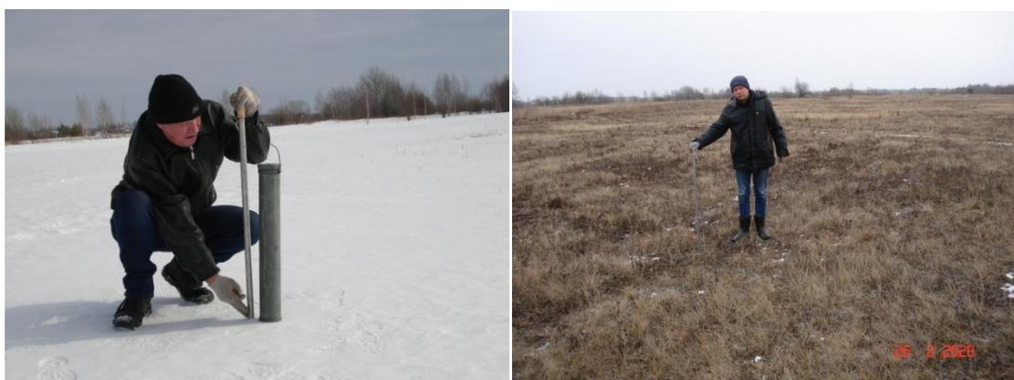
Рисунок 2 – Определение высоты снежного покрова при помощи переносной снегомерной рейки (слева земли АО «Московское» Рязанская область, 2019 год) и фиксирование факта отсутствия устойчивого снежного покрова при проведении снегомерной съемки (справа мелиорированные земли АО «Московское» Рязанская область, 2020 год)
