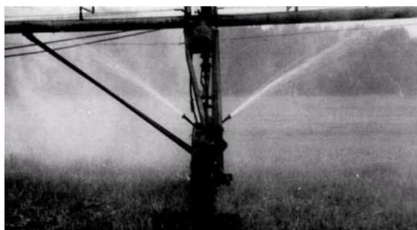
Рисунок 4 – Слив модернизированной системой ДМ «Фрегат»
