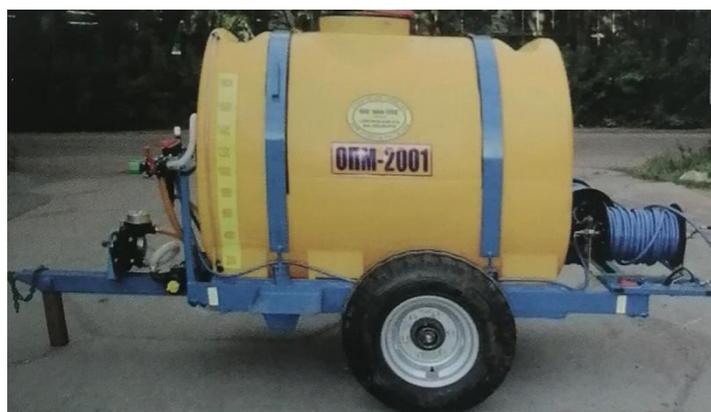
Рисунок 5 – Машина для дезинфекции помещений и зерноскладов МДП-2006
