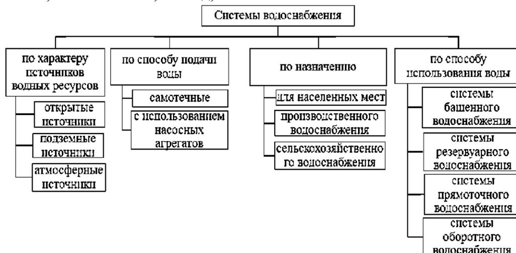
Рисунок 2 – Системы водоснабжения
