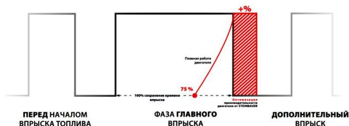
Рисунок 2 – График фаз впрыска топлива при использовании оптимизирующего модуля
