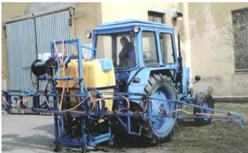
Рисунок 2 – Навесной опрыскиватель ОНШ-600С
