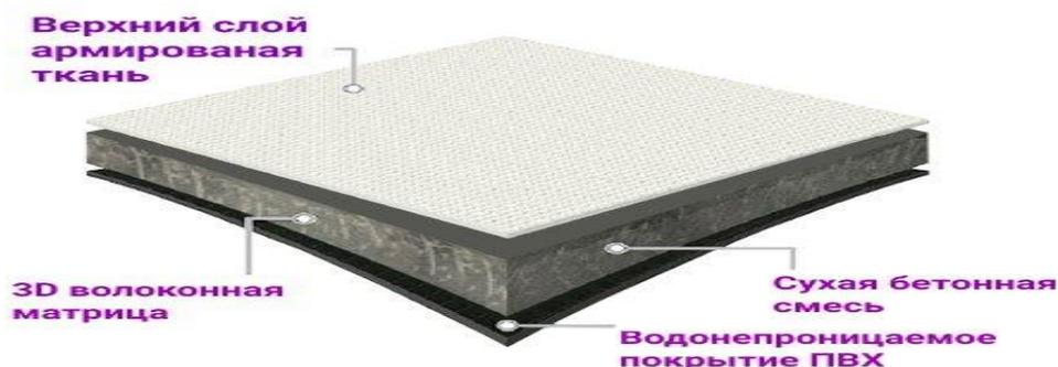
Рисунок 3 – Структура бетонного полотна
