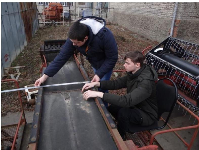
Рисунок 1 – Измерение ширины переборочного стола
