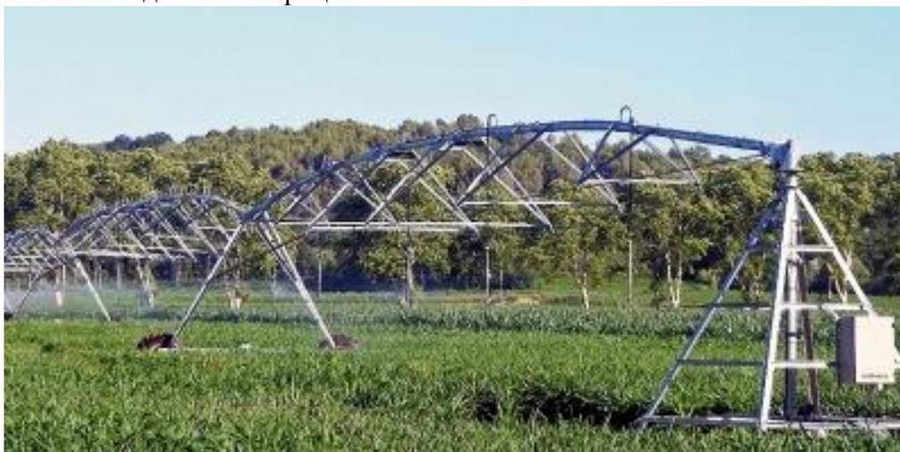
Рисунок 4 – Стационарная дождевальная машина
