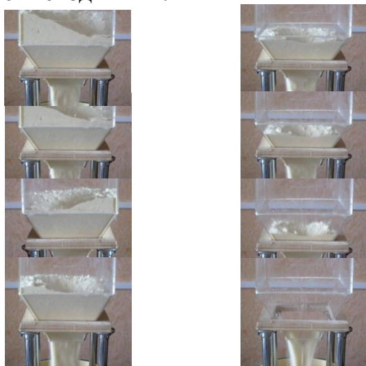
Рисунок 4 – Процесс истечения сыпучего материала из бункера
