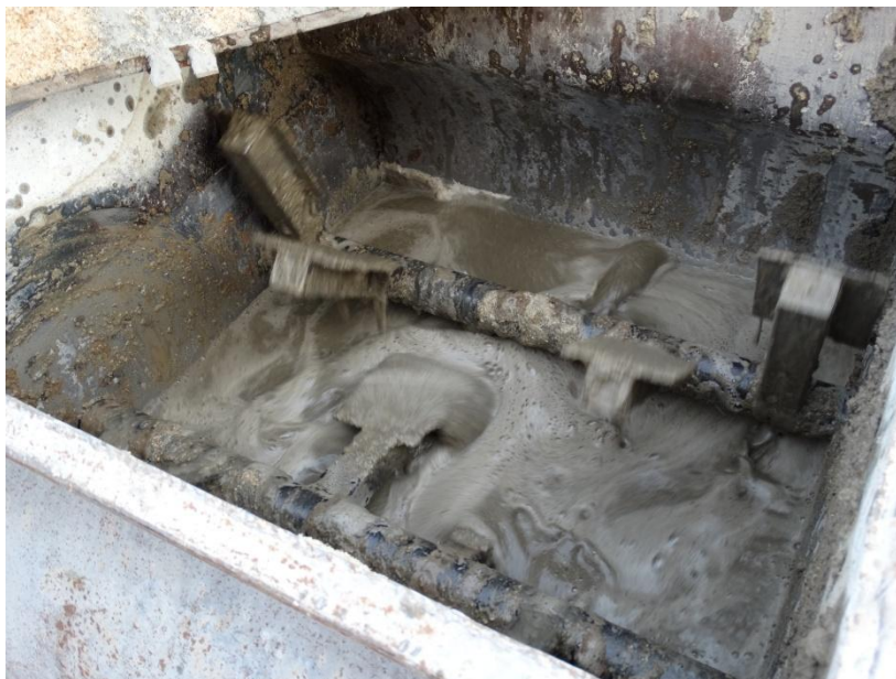
Рисунок 7 – Двухвальный растворосмеситель активного типа.
