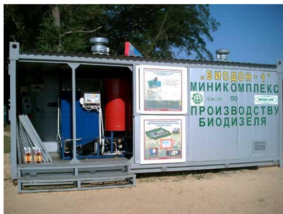
Рисунок 1- Установка контейнерного типа для производства биодизеля
