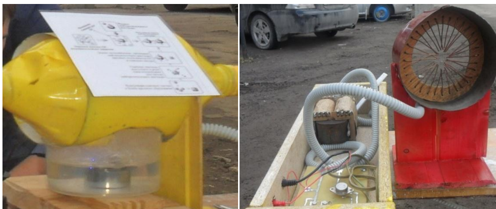
Рисунок 4 – Элементы жидкостного нейтрализатора: жидкостной парообразователь (слева), ионизирующая камера (справа)
