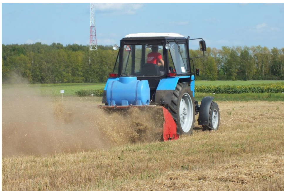
Рисунок 1 – Модернизированный агрегат для утилизации незерновой части урожая в качестве удобрения на полевых испытаниях в УНИЦ «Агротехнопарк» ФГБОУ ВО РГАТУ, август 2019 года
