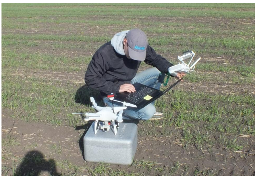
Рисунок 3 – Подготовка квадрокоптера dji phantom 4 pro с дополнительной мультиспектральной камеры Parrot Sequoia к полёту
