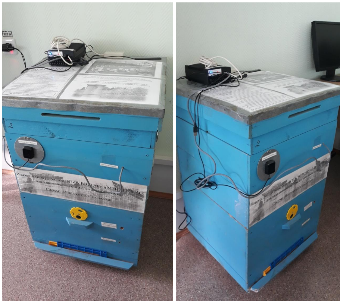
Рисунок 2 - Опытный образец улья, оборудованный навигационно-связным устройством
