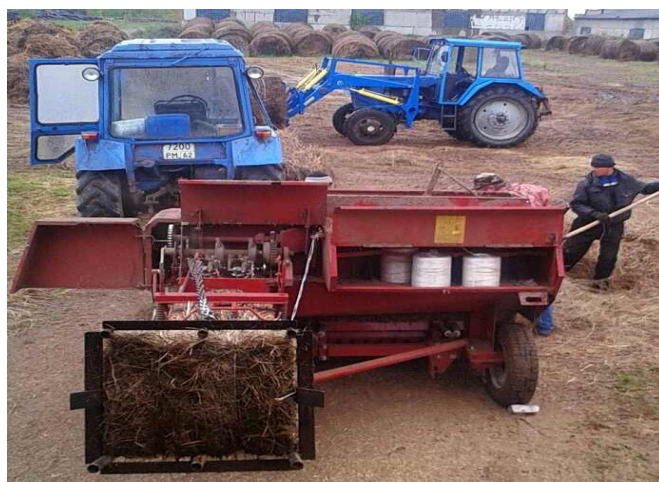
Рисунок 1 – Перепрессовка сена в малогабаритные тюки прямоугольной формы и погрузка их в транспортное средство
