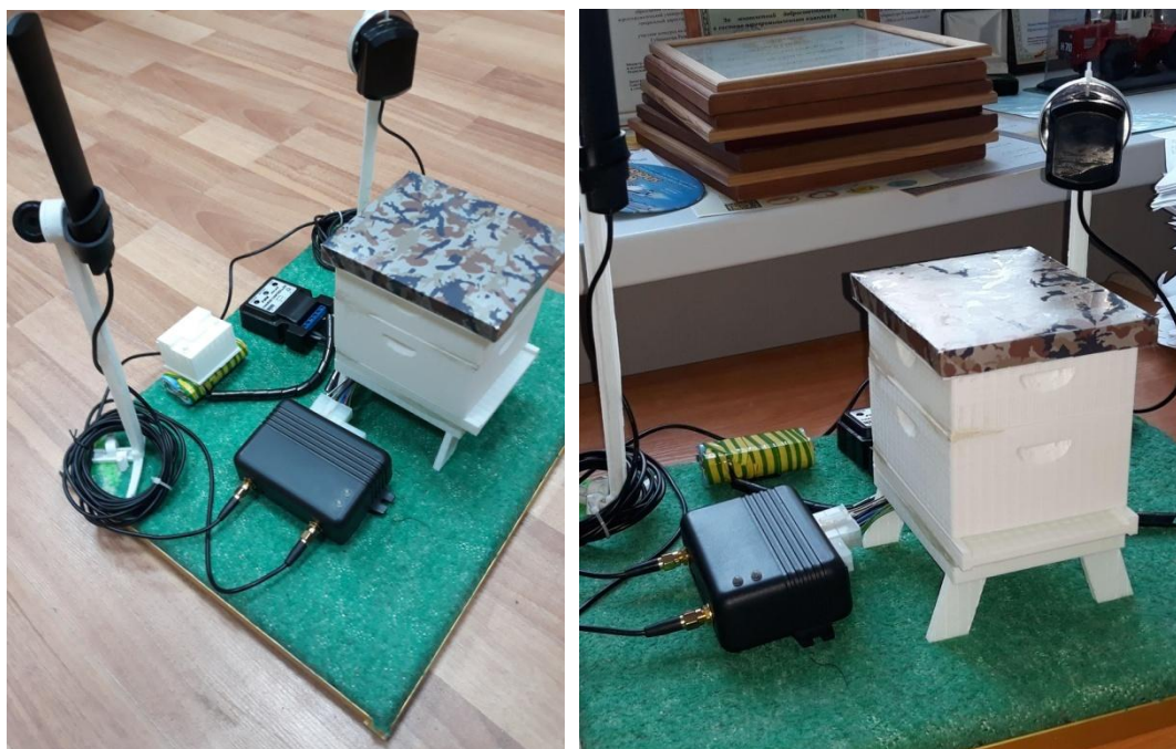
Рисунок 3. – Макет системы с автономной системой питания для удаленных пчесек.
