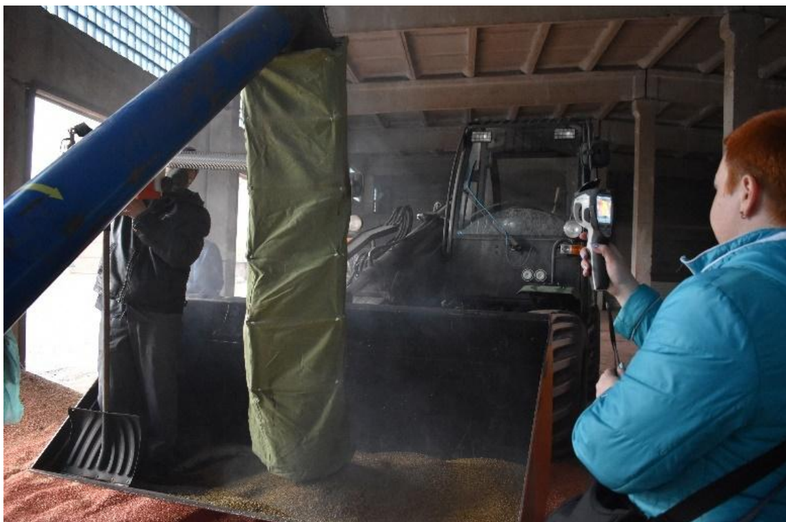
Рисунок 4 – Общий вид обработки зерна с помощью генератора горячего тумана GreenFogBF-130 и измерения тепловизором RGKTL-80
