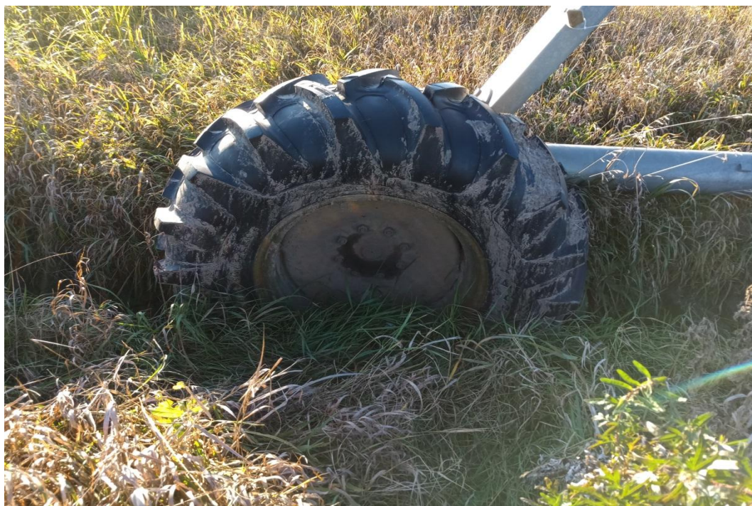
Рисунок 2 – Общий вид погружения колесного движителя ходовых систем «Кубань-ЛК1» в колею
