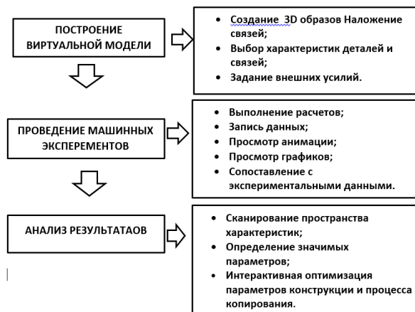
Рисунок 1 – Последовательность действий при разработке виртуальной модели и выполнении машинного анализа рабочего процесса
