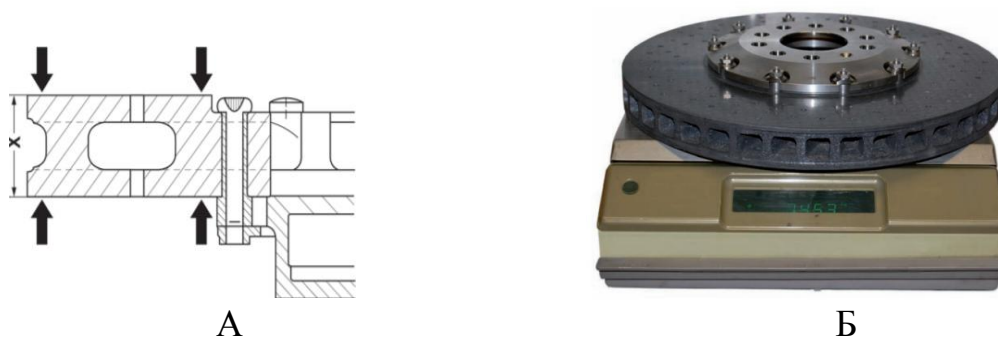
Рисунок 1 – Измерение износа тормозного диска
