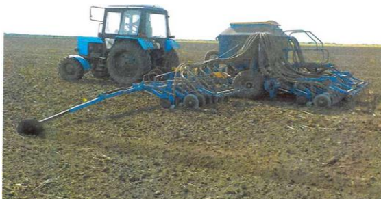
Рисунок 1 – Сеялка С-7,2ПМ4 в агрегате с трактором МТЗ-82 в работе
