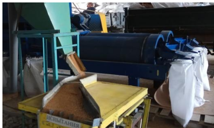
Рисунок 2– Сепаратор в работе в составе поточной линии послеуборочной обработки семян учебно-научно-опытного поля ФГБОУ ВО Пермский ГАТУ
