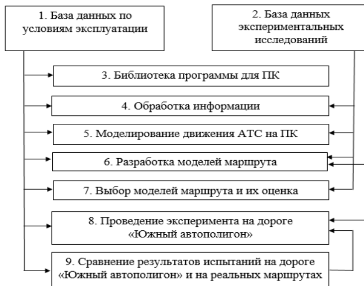
Рисунок 1 – Общая логическая структурная схема получения модели маршрута для сравнительных испытаний АТС на дороге «Южный автополигон»
