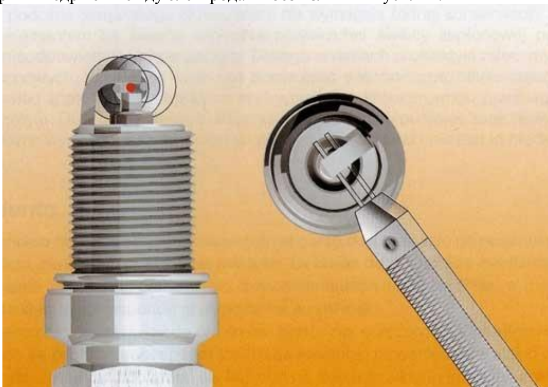
Рисунок 4 – Проверка зазора между электродами
