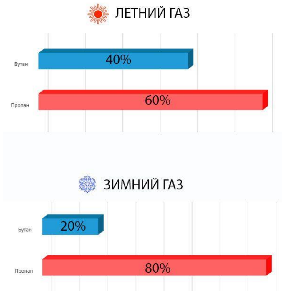
Рисунок 1 – Соотношение пропана и бутана в «летнем» и «зимнем» газовом топливе
