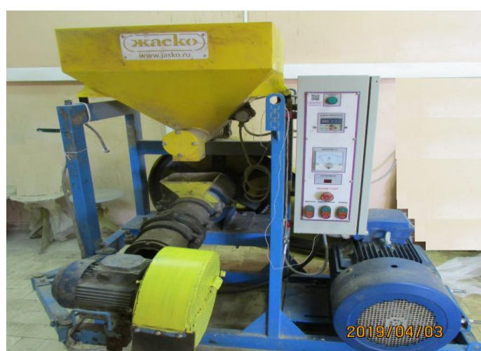
Рисунок 2 – Внешний вид пресс-экструдера компании «Жаско»
