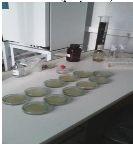
Рисунок 2 – Определение колифагов титрационным методом (чашки с застывшим агаром)
