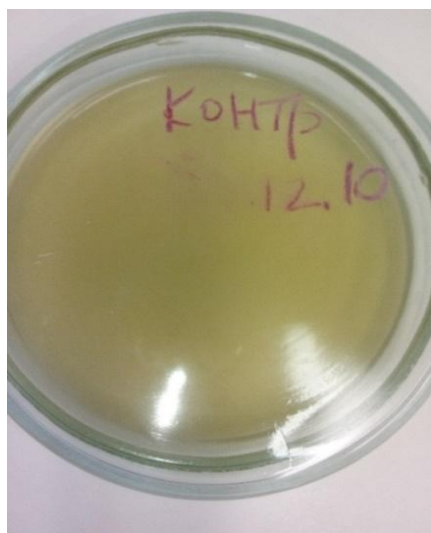
Рисунок 3 – Определение колифагов титрационным методом (отрицательный контроль)
