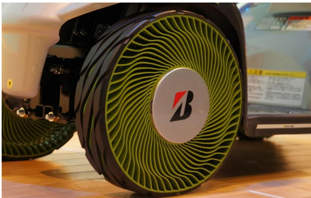
Рисунок 3 – Колесо со спицами – простенками
