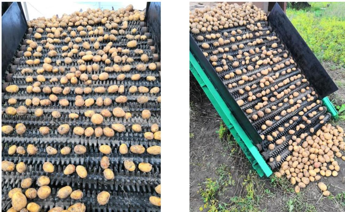
Рисунок 1 – Навесное перегрузочное устройство для самосвального кузова транспортного средства
