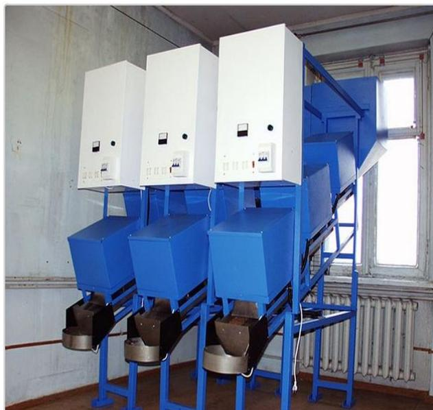
Рисунок 1 – Пример СВЧ-установки для предпосевной обработки семян
