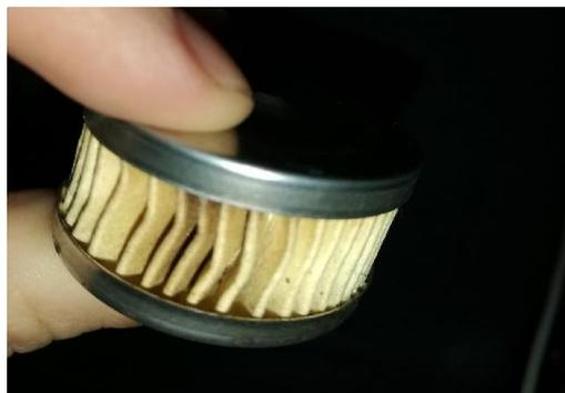
Рисунок 8 – Извлечение старого фильтра
