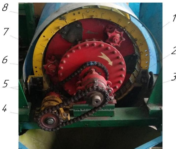
1 – дека прутково-планчатая; 2 – опорно-приводной вал аксиального ротора; 3 – основная звездочка привода зубчато-цевочного зацепления; 4 – промежуточный вал в сборе; 5 – цепная передача  $t = 19,05$  мм; 6 – цевочное колесо; 7 – сменная звездочка привода цевочного колеса; 8 – звездочка вальца-сателлита ротора.
