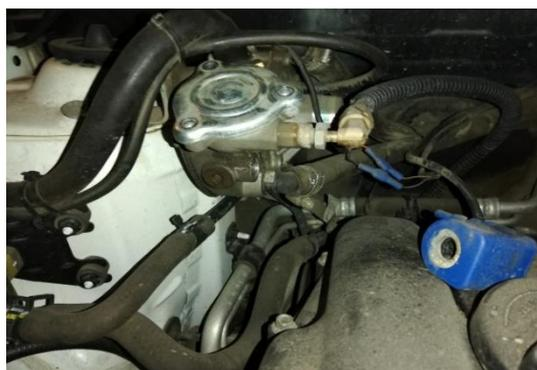
Рисунок 3 – Извлечение клапана из редуктора
