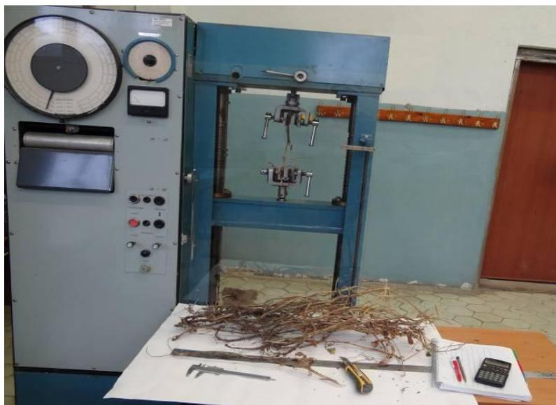
Рисунок 3 – Испытание образцов картофельной ботвы на разрывной машине Р-05-11
