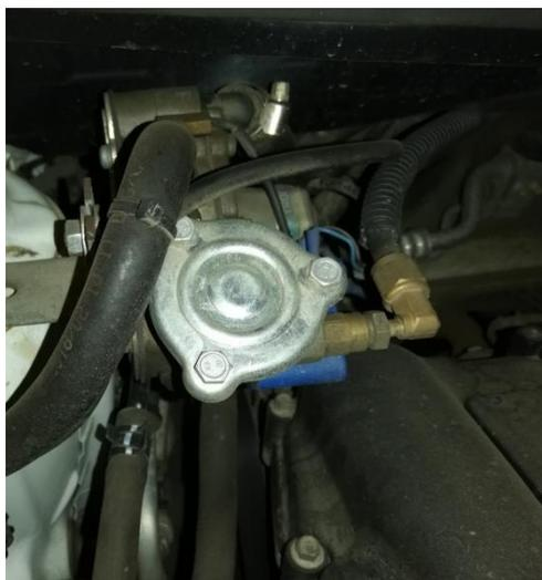
Рисунок 1 – Редуктор газовый фирмы Tomasetto
