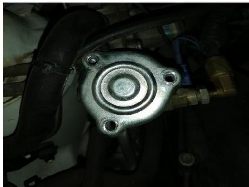
Рисунок 7 – Снятие крышки для замены фильтра грубой очистки топлива
