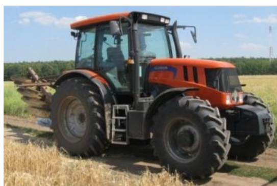
Рисунок 1 – Опытный пахотный агрегат АТМ 3180 «Terrion» + ПЛН-5-35
