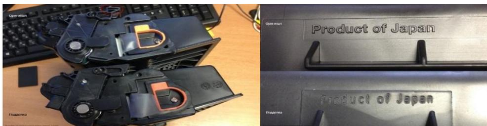
Рисунок 3 – Вид боковых поверхностей картриджей (сверху оригинал, внизу - исследуемый образец)
