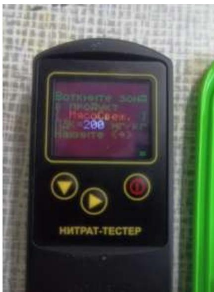
Рисунок 2 – Измерение количества нитратов нитрат-тестером НУК-019-2
