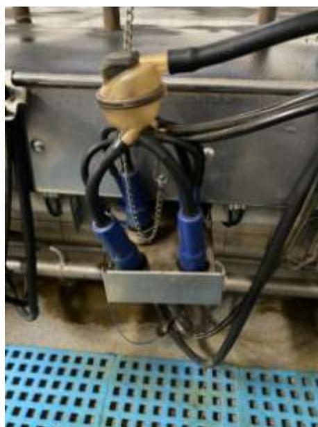
Рисунок 5 – Подвесная часть доильного аппарата
