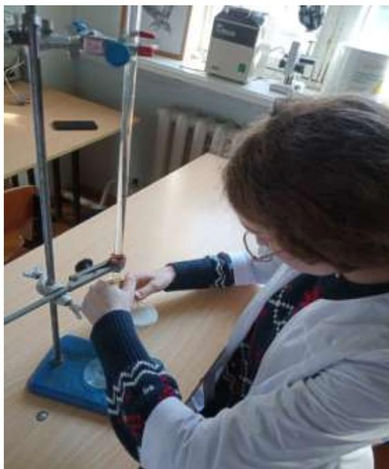
Рисунок 1 – Определение титруемой кислотности первой пробы
