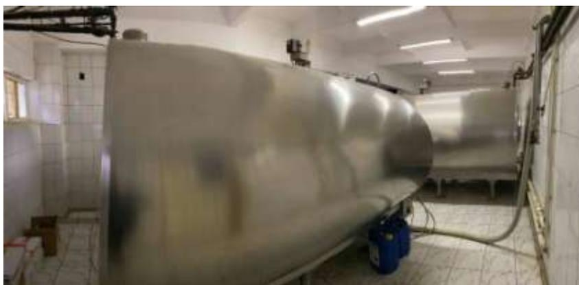
Рисунок 6 – Танк охладитель
