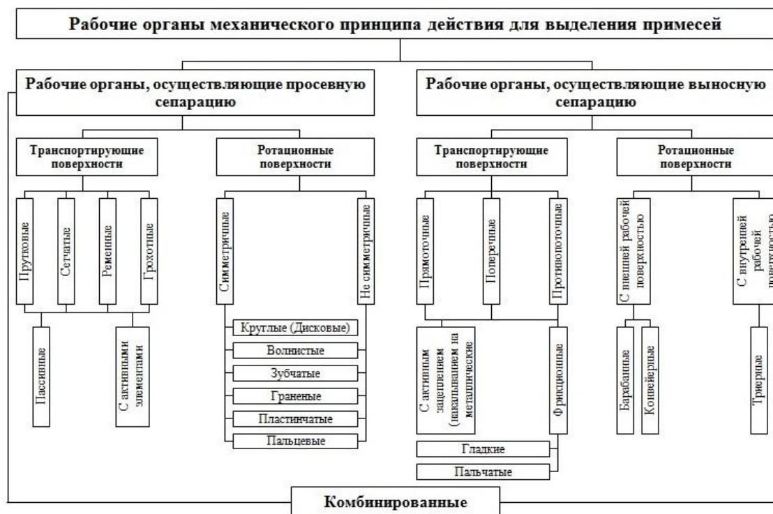
Рисунок 1 – Классификация сепараторов механического принципа действия
