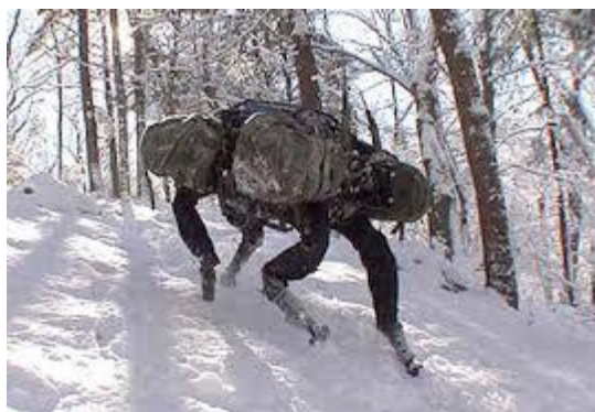
Рисунок 5 – Робот BigDog: подъём в гору
