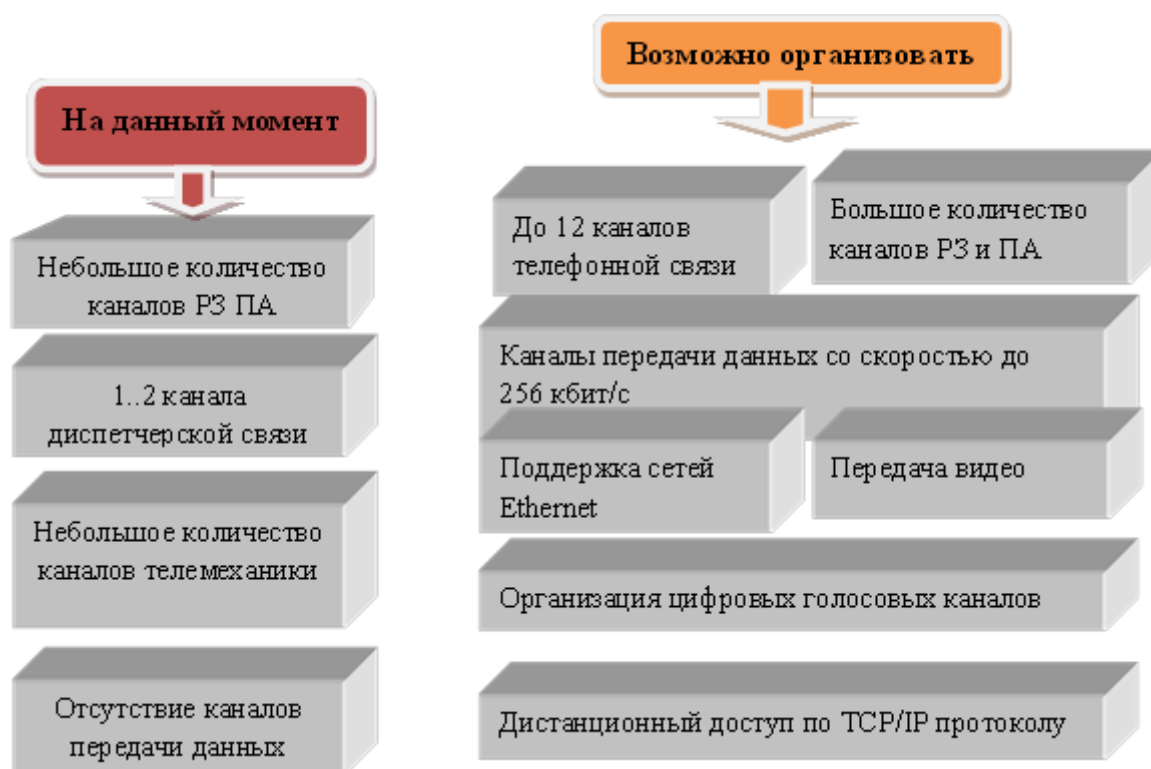
Рисунок 4 – Схема сравнения существующих каналов связи до и после модернизации.
