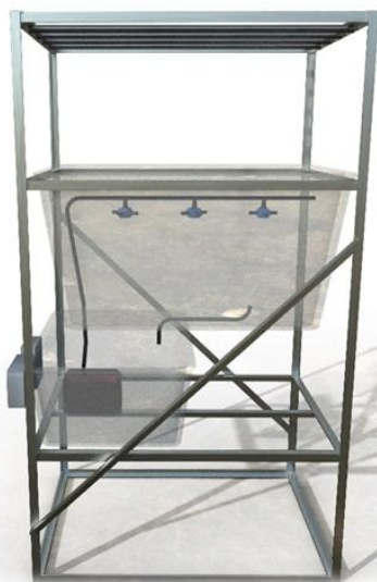
Рисунок 1 – Разработанный школьниками проект – адаптационная установка для растений, выращиваемых в условиях in vitro
