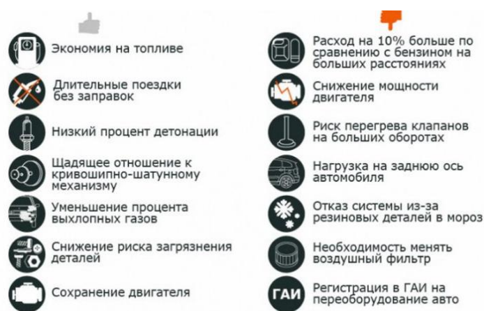
Рисунок 1 – Положительные и отрицательные стороны установки газобаллонного оборудования
