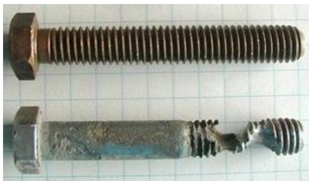
Рисунок 3 – Коррозионное разрушение болта при щелевой коррозии
