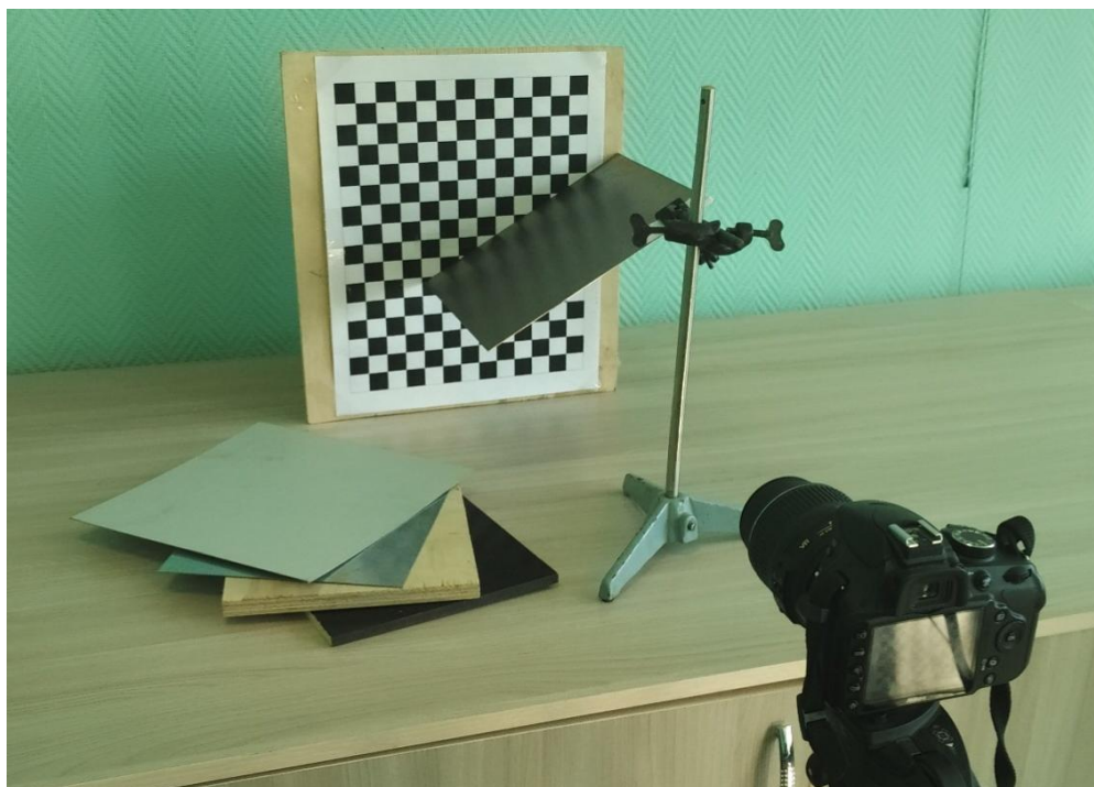
Рисунок 2 – Общий вид лабораторной установки для исследования процесса движения зерна
