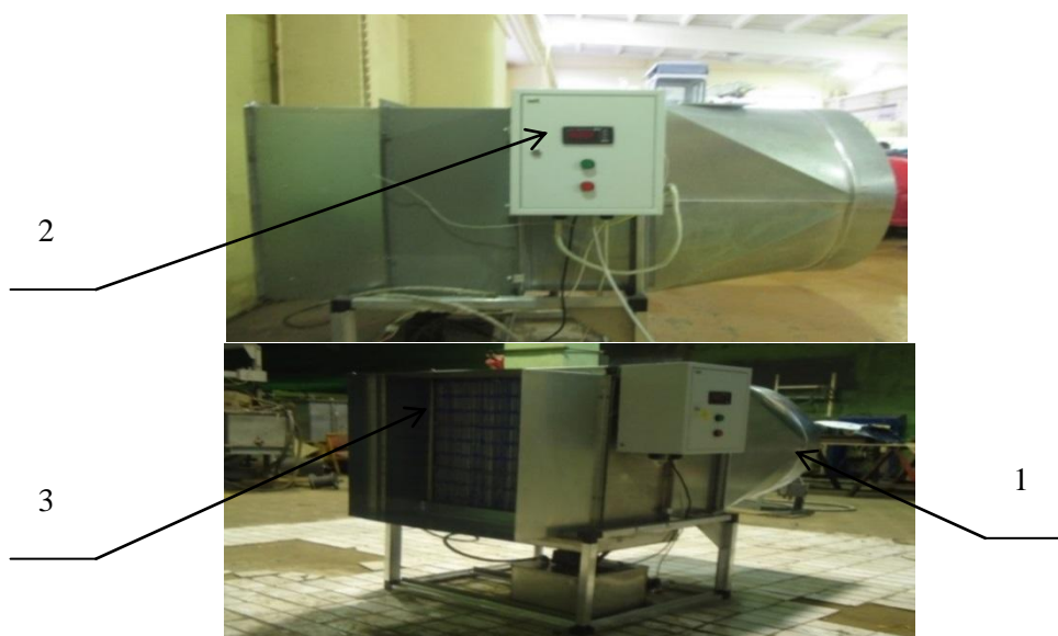
Рисунок 2– Водоиспарительный пластинчатый охладитель воздуха (охладительный блок)
