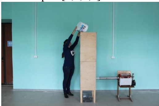
Рисунок 1 - Общий вид установки для предпосевной обработки семян аэрозолем защитно-стимулирующими веществами
