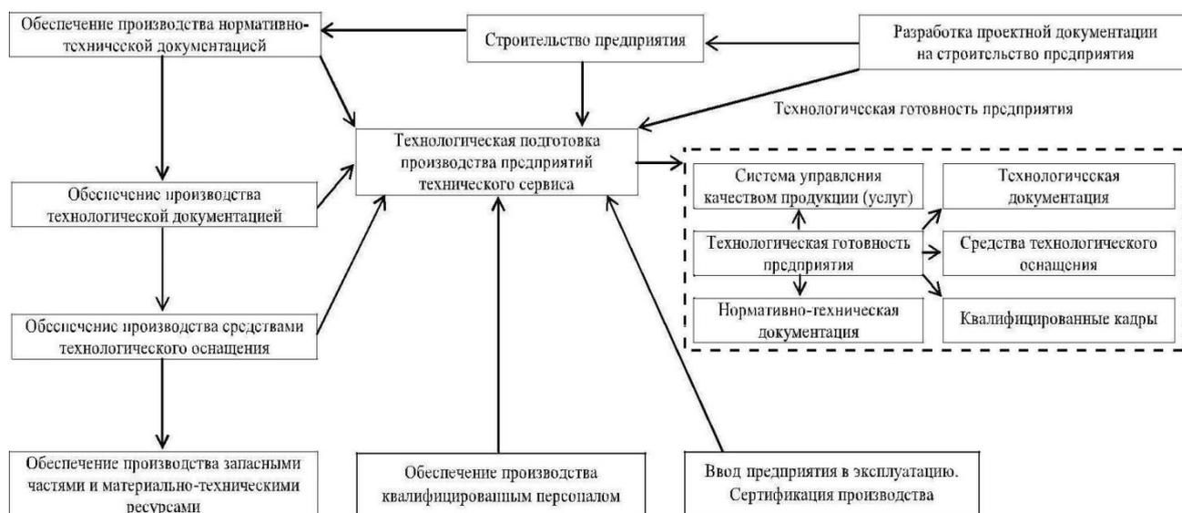
Рисунок 2 -Схема сетевого графика технологической подготовки производства
