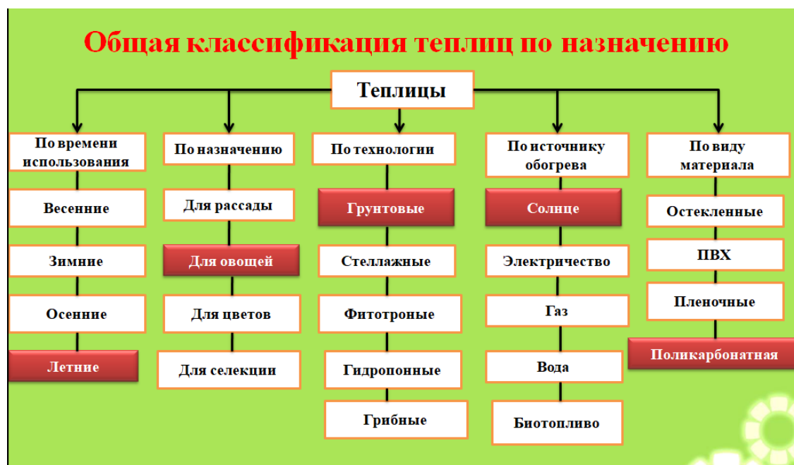
Рисунок 1 – Схема общей классификации теплиц по назначению
