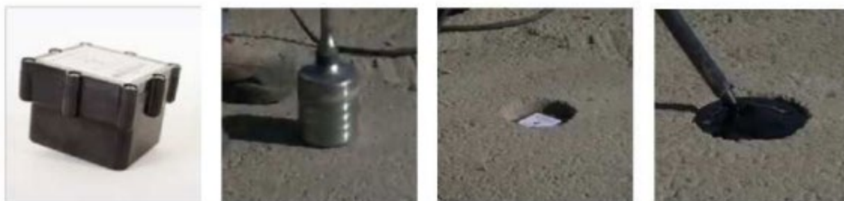
Рисунок 2 – Пример датчика вибрации
