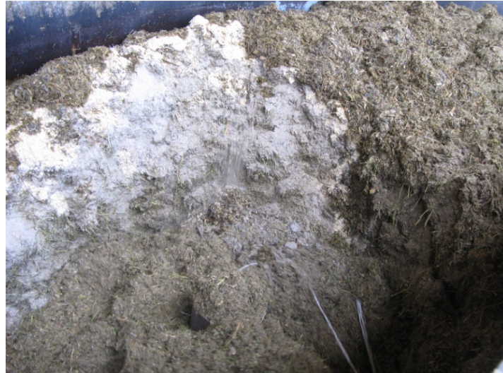
Рисунок 1 – Неперемешанный верхний слой в смесителе
