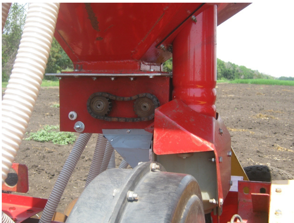
Рисунок 2 – Общий вид расположения катушечно-штифтового высеваящего аппарата на селекционной сеялке ССНП-16
