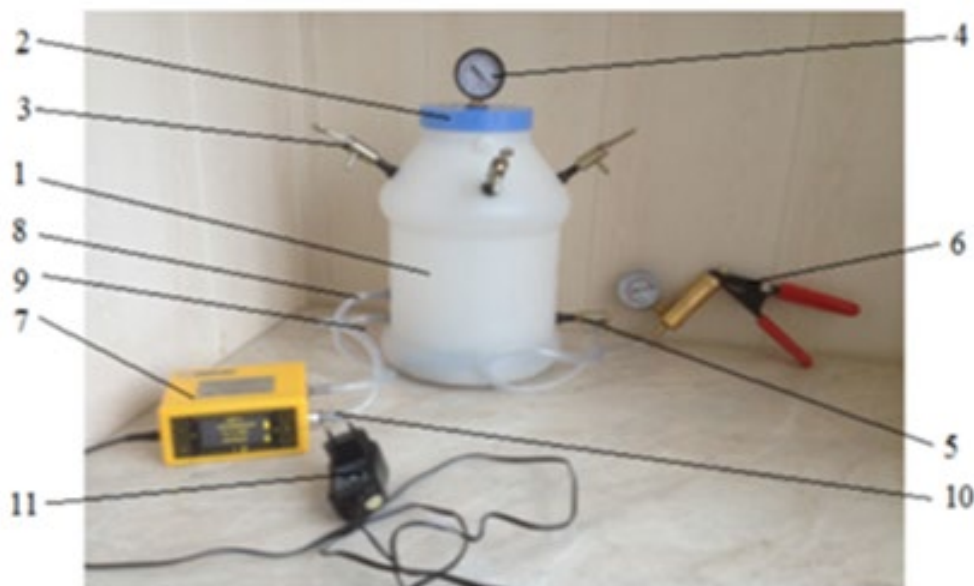
1 – емкость, 2 – крышка герметичная, 3 – клапан, 4 – контрольный вакуумметр, 5 – клапан с золотником, 6 - насос, 7 – сигнализатор, 8 – дроссель на входе, 9 – дроссель на выходе, 10 – фильтр воздушный, 11 - зарядка
