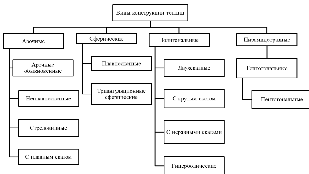
Рисунок 2 – Схема классификации теплиц по конструкции
