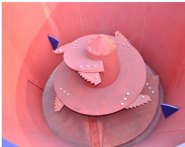
Рисунок 4 – Пример установки более толстых ножей в верхней части шнека
