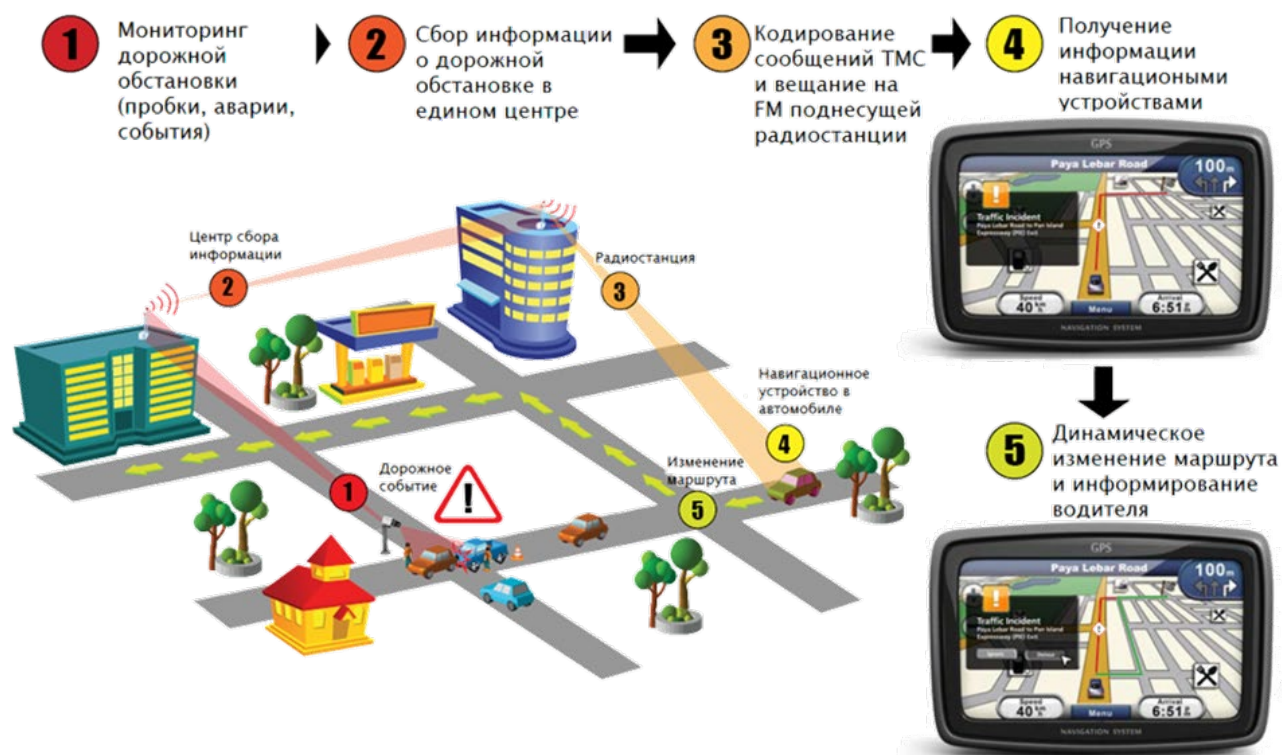
Рисунок – Схема функционирования системы навигации
