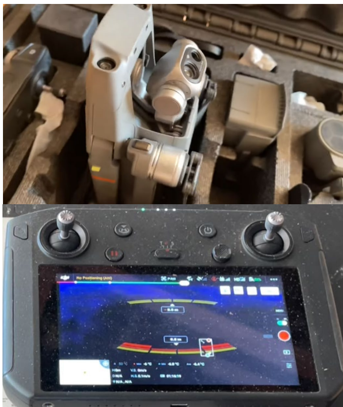
Рисунок 5 – Квадрокоптер с тепловизионной камерой и изображение области, где необходимо ставить аэратор
