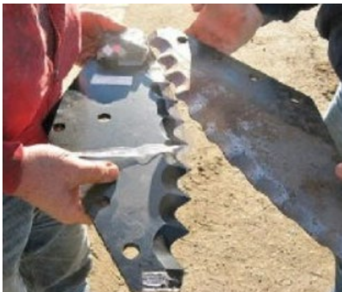
Рисунок 3 – Сравнение нового и износившегося ножей
