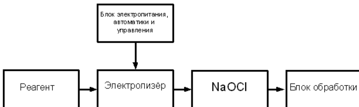
Рисунок 1 – Структурная схема электролизной установки
