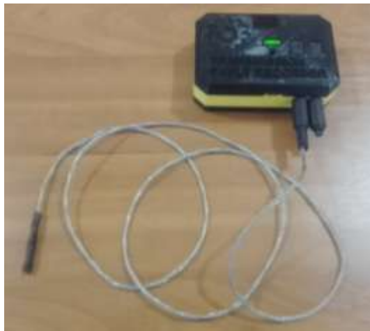
Рисунок 4 – Общий вид цифрового регистратора с автоматической корректировкой по температуре окружающей среды
