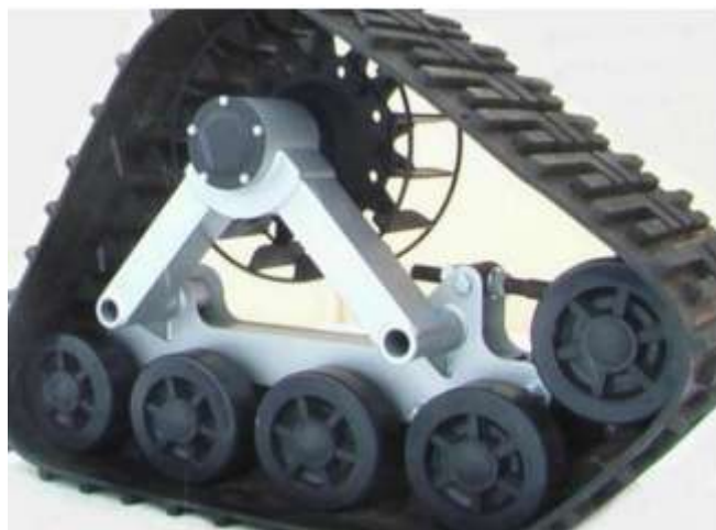
Рисунок 1 – Универсальный гусеничный движитель для колесной техники
