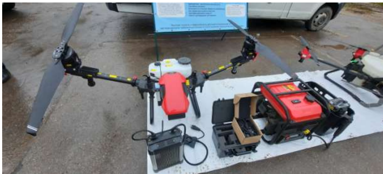
Рисунок 2 – БПЛА для опрыскивания с/х культур с комплектом необходимого оборудования
