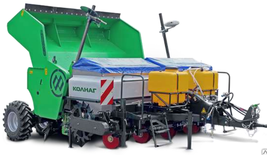
Рисунок 1 – Картофелесажалка MIEDEMA CP42P изготовитель ЗАО «КОЛНАГ»
