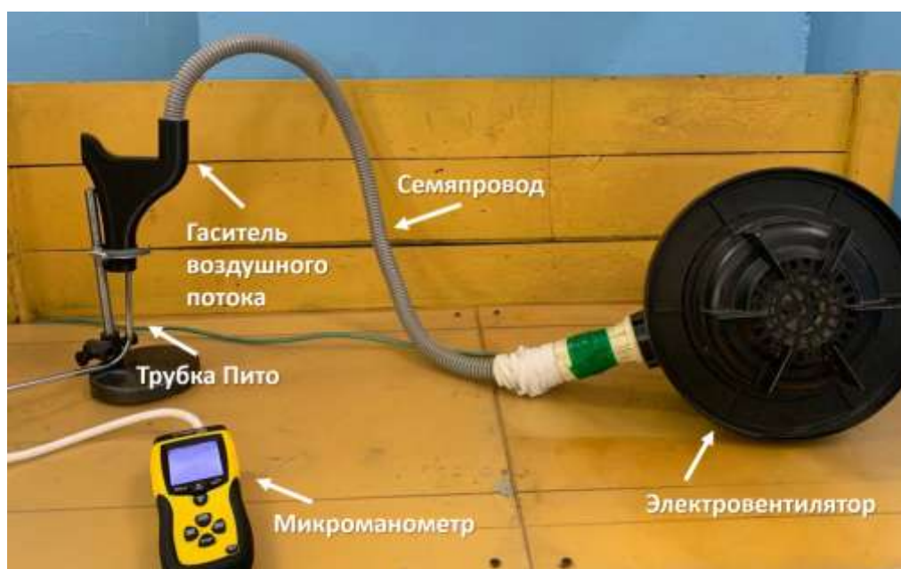
Рисунок 2 – Лабораторная установка для проверки работы гасителей
