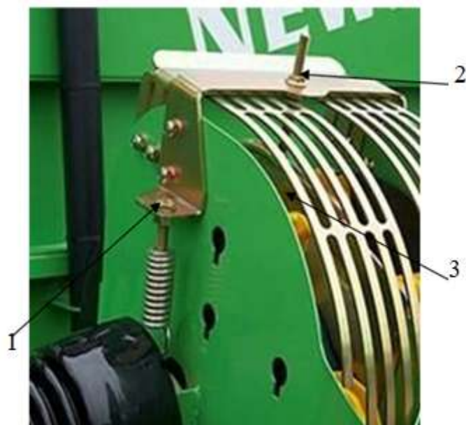
1 – винт регулировочный; 2 – винт; 3 – скоба делителя Риунок 3 – Регулировка чашечного транспортера
