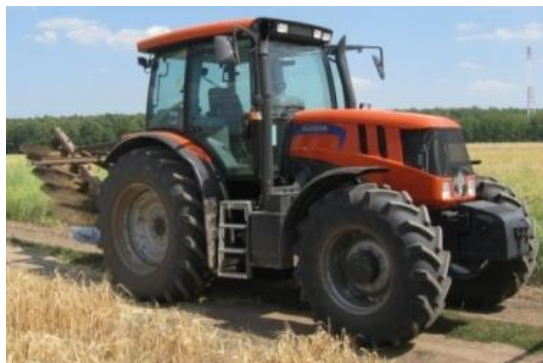
Рисунок 1 – Опытный пахотный агрегат АТМ 3180 «Terrion» + ПЛН-5-35
