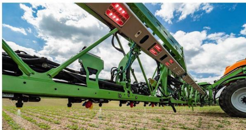
Рисунок 2 – Активный источник света для точного распознавания сорняков.
