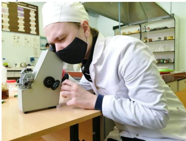
Рисунок 1 – Определение содержания воды рефрактометрическим методом.
