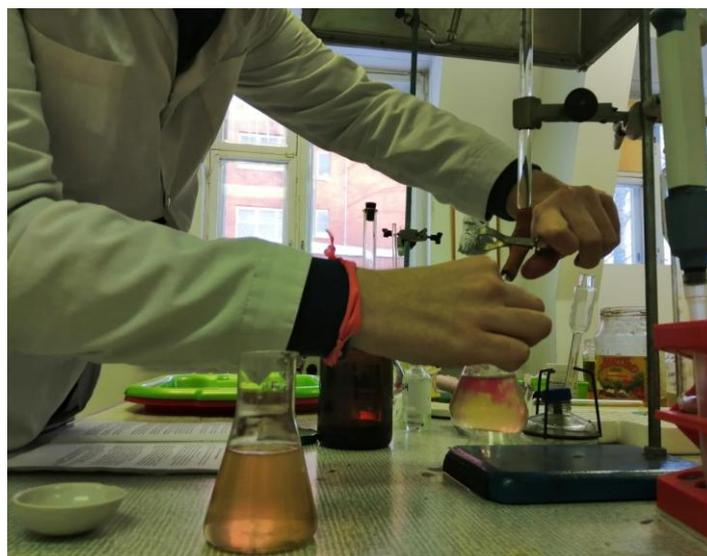
Рисунок 2 – Определение кислотности меда.
