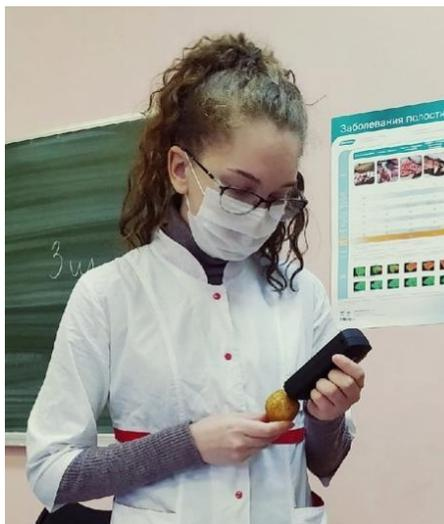
Рисунок 1 – Определение содержания нитратов в картофеле нитрат-тестером «СОЭКС»
