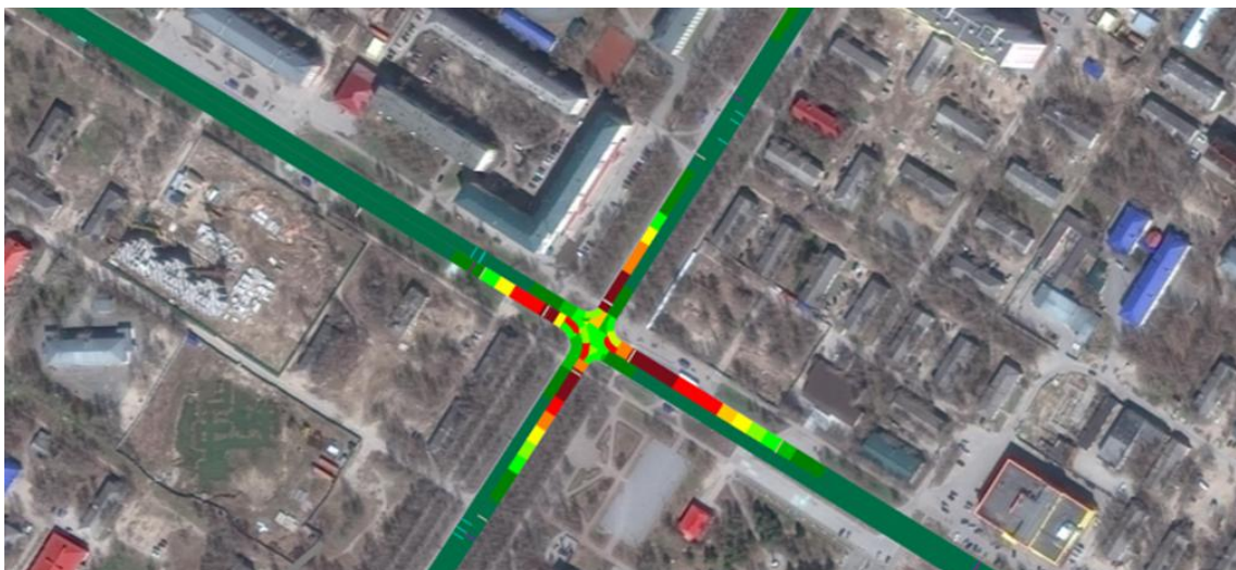
Рисунок 13 – Распределение скоростей движения транспортных средств на пересечении
