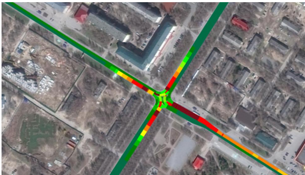
Рисунок 10 – Распределение скоростей движения транспортных средств на пересечении
