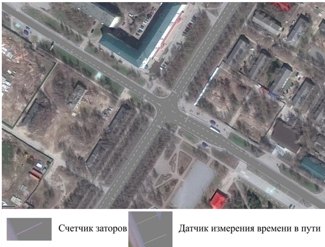
Рисунок 9 – Измерительные датчики на пересечении
