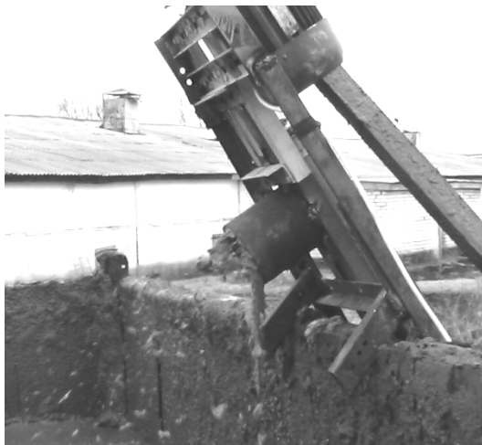
Рисунок 2.1 – Процесс выгрузки помёта смешанного с органическими включениями (перья, отходы откорма, скорлупа)
