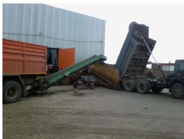
Рисунок 3 – Одновременная выгрузка картофеля в приёмный бункер по двухканальной системе: из самосвала и из автомобиля с кузовом, оборудованным подвижным дном
