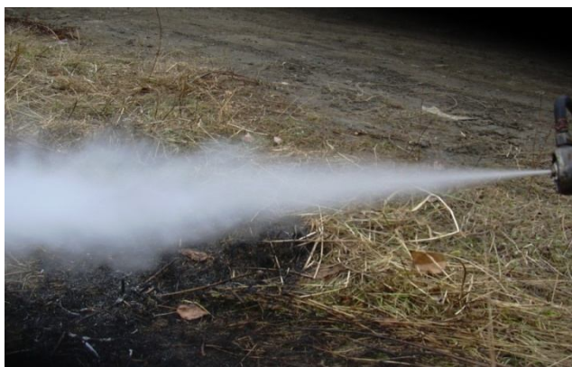
Рисунок 1 – Стадии тушения низового пожара струей переохлажденного водяного пара
