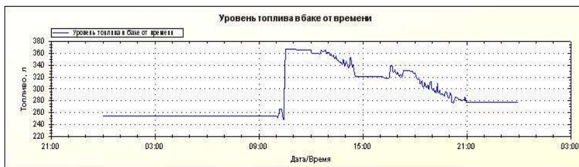
Рисунок 2 – Данные датчиков системы спутникового контроля и мониторинга по расходу топлива
