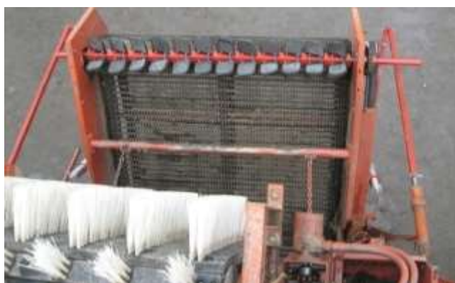
Рисунок 2 – Адаптирующие органы комбайна DR-1500: а) орган первичной сепарации [5], б) орган вторичной сепарации [4,11]
