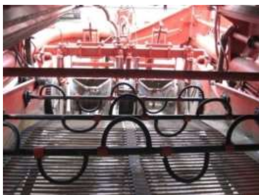
Рисунок 2 – Адаптирующие органы комбайна DR-1500: а) орган первичной сепарации [5], б) орган вторичной сепарации [4,11]
