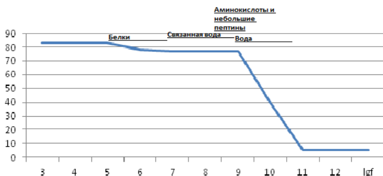
Рисунок 1 – Дисперсия диэлектрической проницаемости белков и некоторых других молекул
