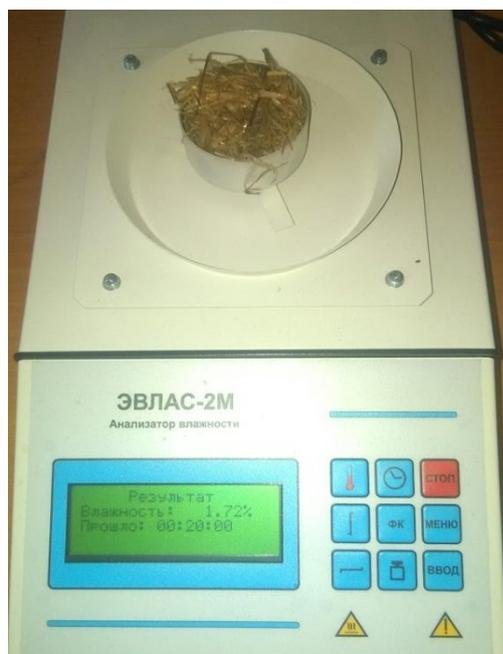
Рисунок 2 – Измерение влажности образцов НЧУ при помощи влагомера ЭВЛАС-2М
