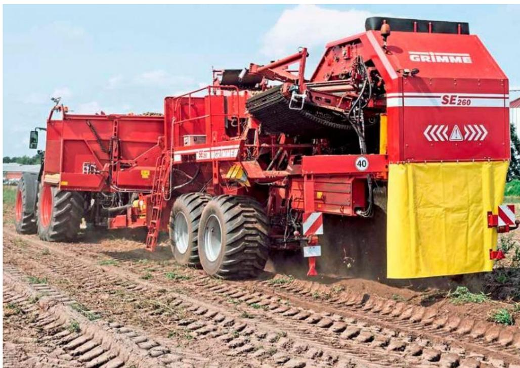
Рисунок 3 - Современный прицепной картофелеуборочный комбайн GRIMME SE 260 с вместительным 6-и тонным бункером.
