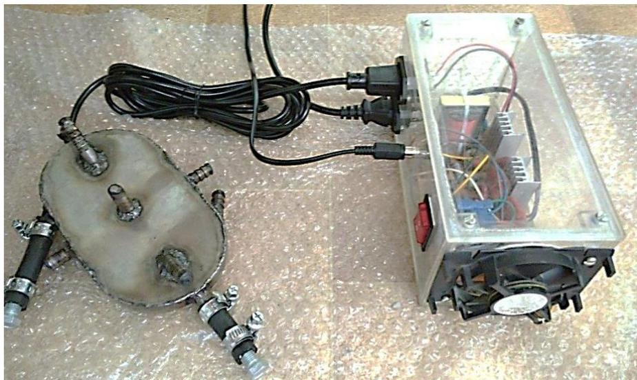
Рисунок 1 – Устройство для ультразвуковой обработки топлива
