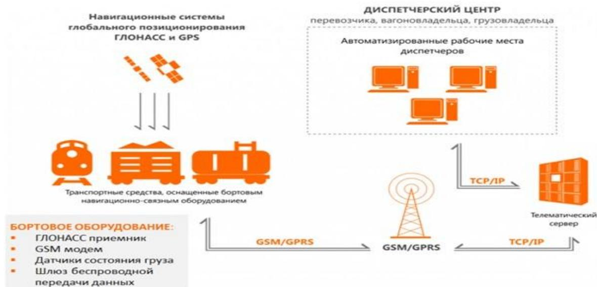
Рисунок 1 – Схема работы системы ГЛОНАСС на грузовых вагонах
