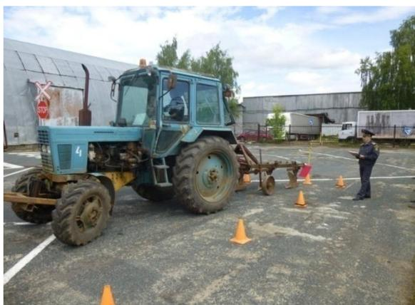
Рисунок 1- Агрегатирование трактора МТЗ 82 с плугом ПЛН 3 – 35
