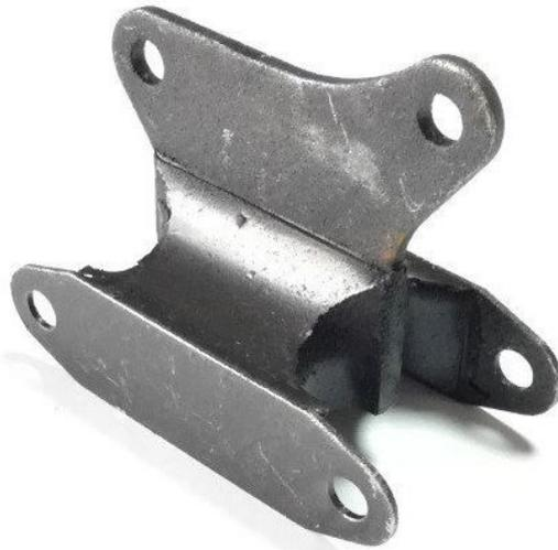
Рисунок 1 – Штатная опора коробки передач ВАЗ-2101
