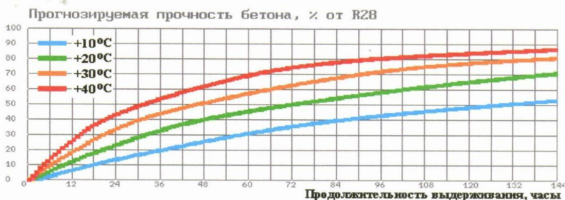
Рисунок 5 – Кривые набора прочности бетоном В25 при изотермическом выдерживании с различными положительными температурами
