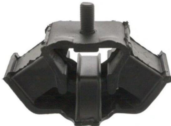
Рисунок 2 - Подушка коробки передач Mercedes W124
