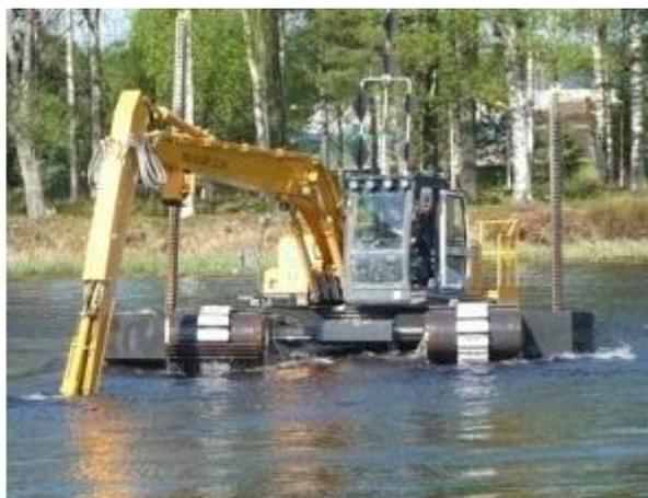
Рисунок 3 – Плавающий экскаватор амфибия
