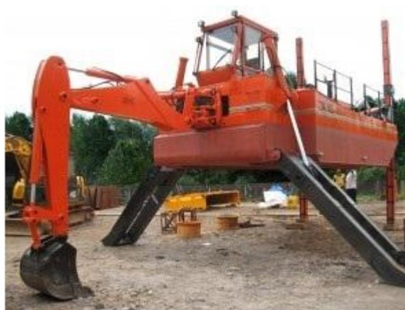
Рисунок 2 – Земснаряды амфибии для очистки и углубления водоемов
