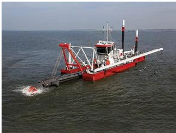
Рисунок 1 – Малогабаритные земснаряды
