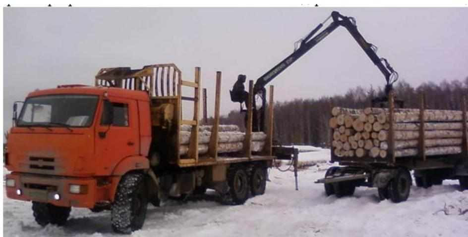
Рисунок 2 - Процесс погрузки древесины в сортиментовозный прицеп
