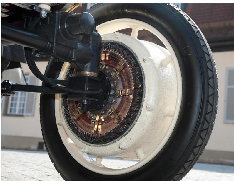
Рисунок 2 – Один из видов реализации мотор-колеса
