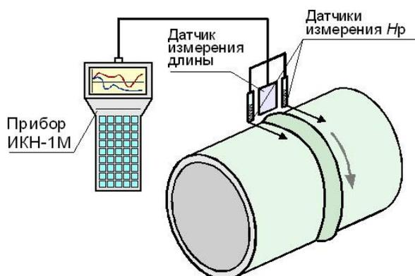
Рисунок 1 - Схема экспресс контроля методом магнитной памяти сварного соединения
