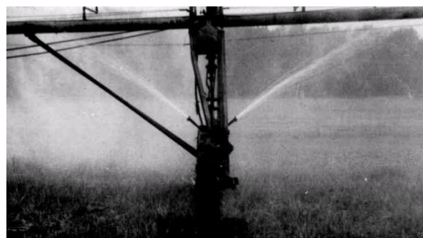
Рисунок 4 – Слив воды из гидропривода ДМ «Фрегат»
