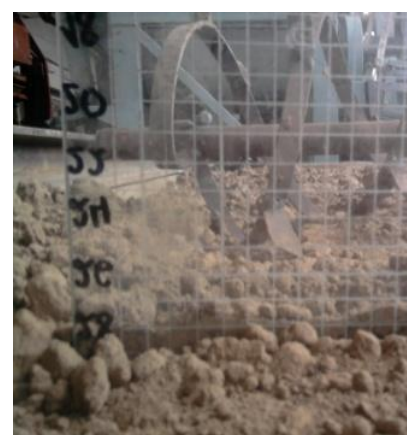
Рисунок 2 – Лабораторная установка для определения оптимальной площади питания и коэффициента структурности для мелкосеменных культур:
