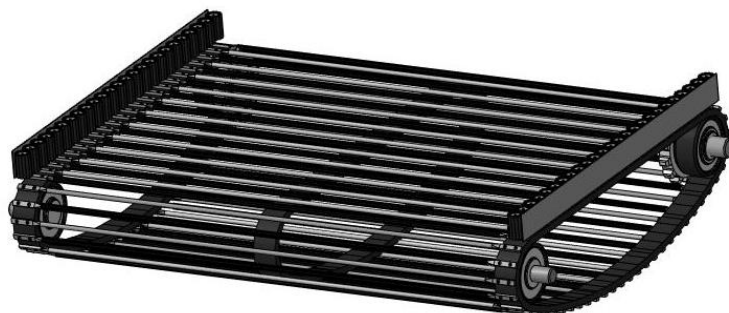
Рисунок 3 – Сепарирующее устройство (патент на изобретение № 2592111)
