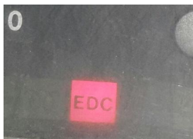
Рисунок 2 – Неисправность топливной системы
