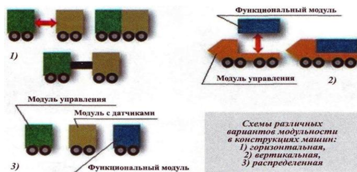
Рисунок 2 – Схемы различных вариантов модульности в конструкциях машин
