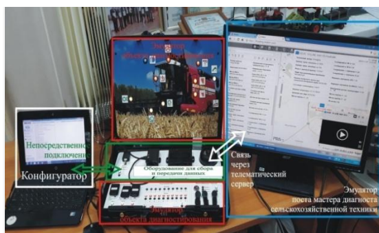
Рисунок 2 – Лабораторная установка для моделирования процесса удаленной диагностики сельскохозяйственной техники
