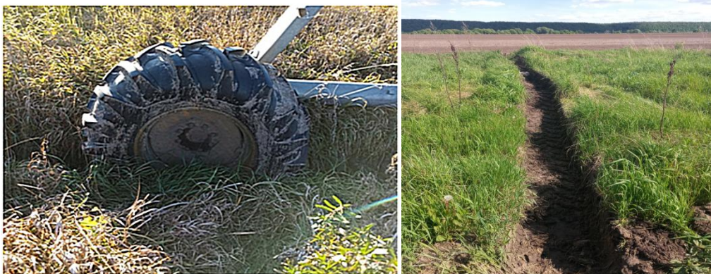
А) Б) Рисунок 1 – Колееобразование ходовой системой ДМ «Кубань-ЛК1»: А) – погружение колеса тележки ДМ, б) – общий вид колеи от ДМ
