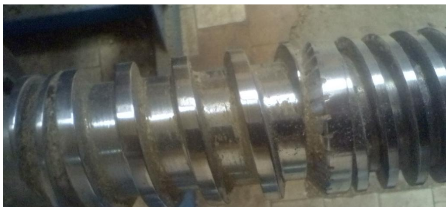
Рисунок 3– Сборка шнеков для экструдирования ингредиентов
