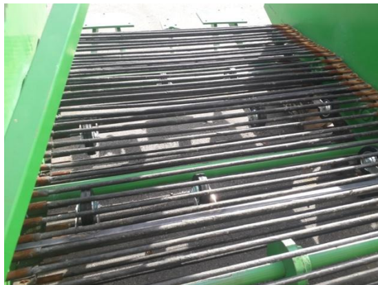
Рисунок 1 – Сепарирующий элеватор с поддерживающими роликами интенсификаторами
