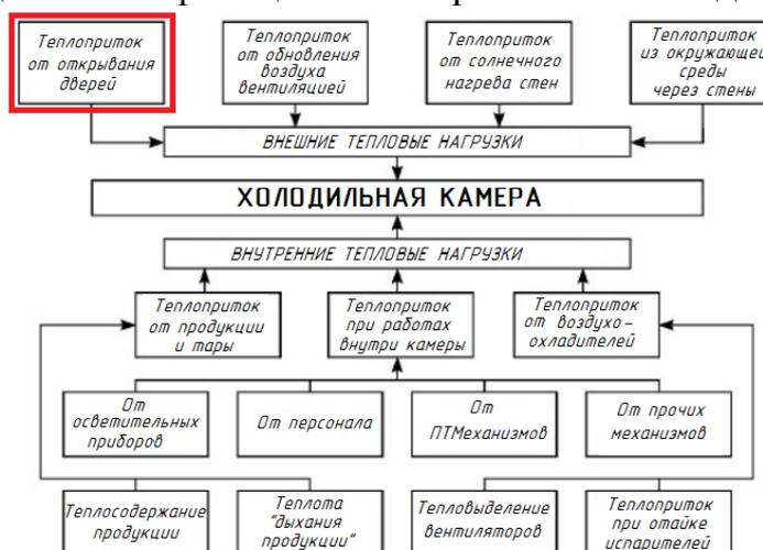
Рисунок 1 – Классификация теплопритоков в холодильную камеру
