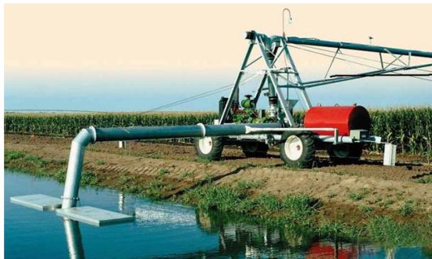
Рисунок 2 – Полустационарная дождевальная машина с неизменным положением насосного аппарата
