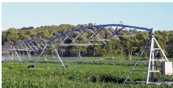
Рисунок 4 – Стационарная дождевальная машина
