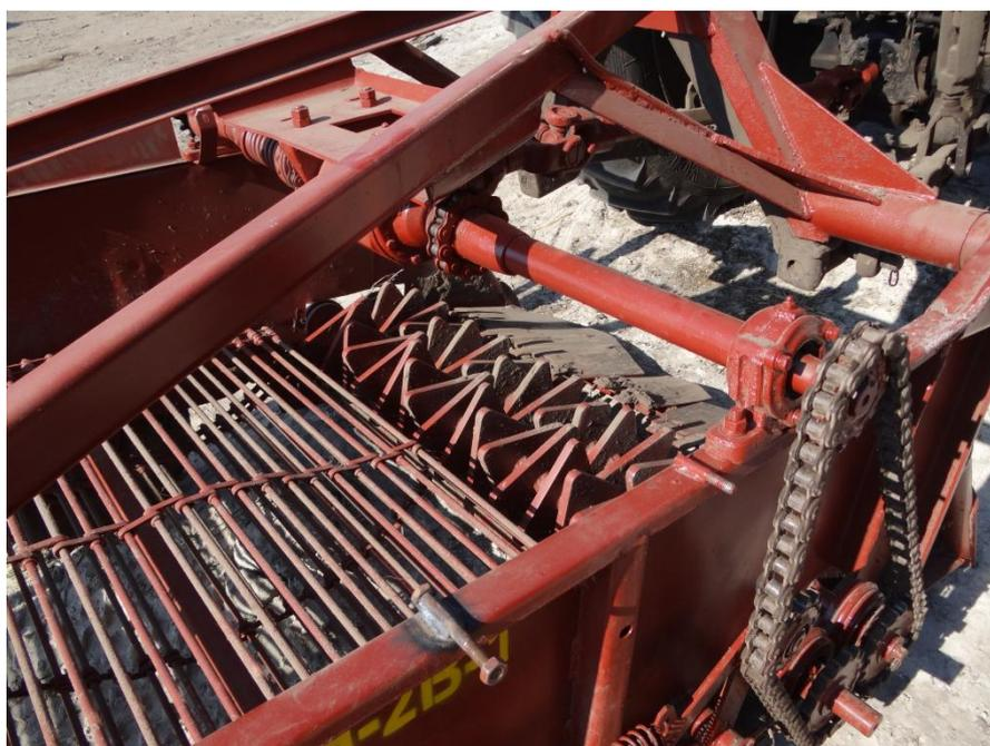
Рисунок 2 – Привод валов-роторов картофелекопателя КТН-2В-1
