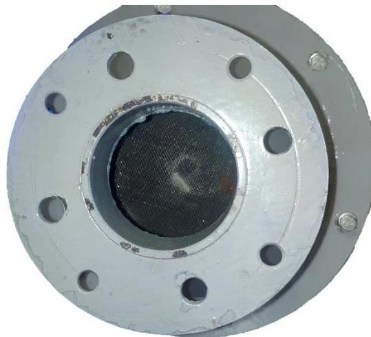
Рисунок 2 – Ионизирующий контур, установленный внутри аэрозольной камеры нейтрализатора
