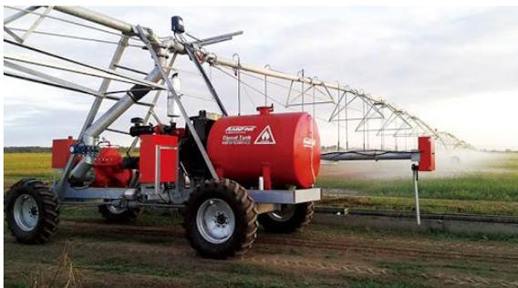
Рисунок 1 – Мобильная (перемещаемая) дождевальная машина
