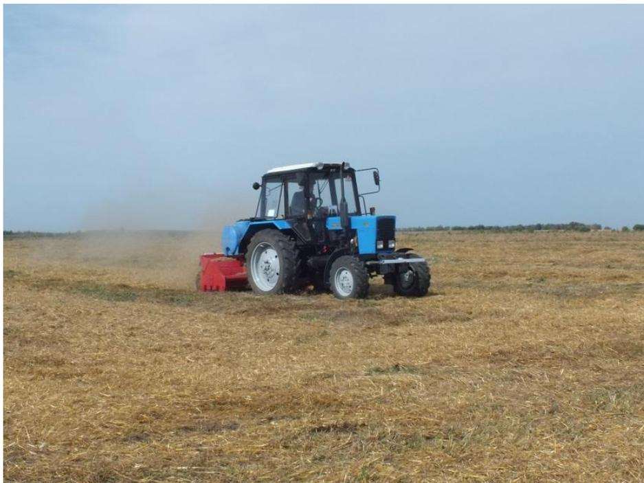
Рисунок 2 – Агрегат для утилизации незерновой части урожая в качестве удобрения
