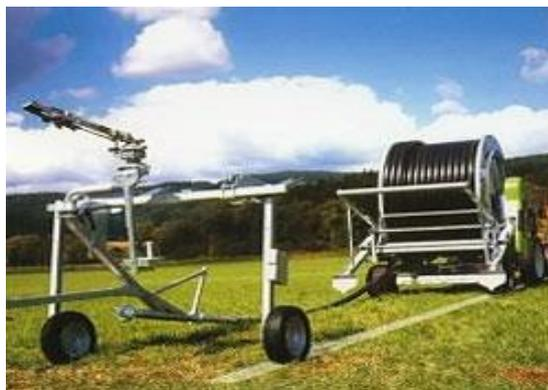
Рисунок 5 – Барабанная дождевальная машина
