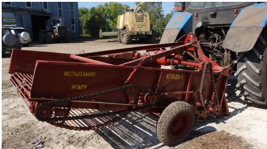
Рисунок 1 – Общий вид картофелекопателя КТН-2В-1
