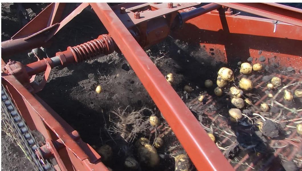
Рисунок 4 – Сепарация почвы на рабочих органах картофелекопателя КТН-2В-1
