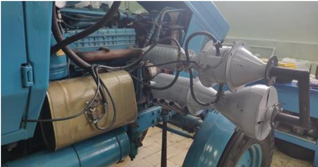
Рисунок 1 – Лабораторные исследования устройства для селективной катализации компонентов отработавших газов
