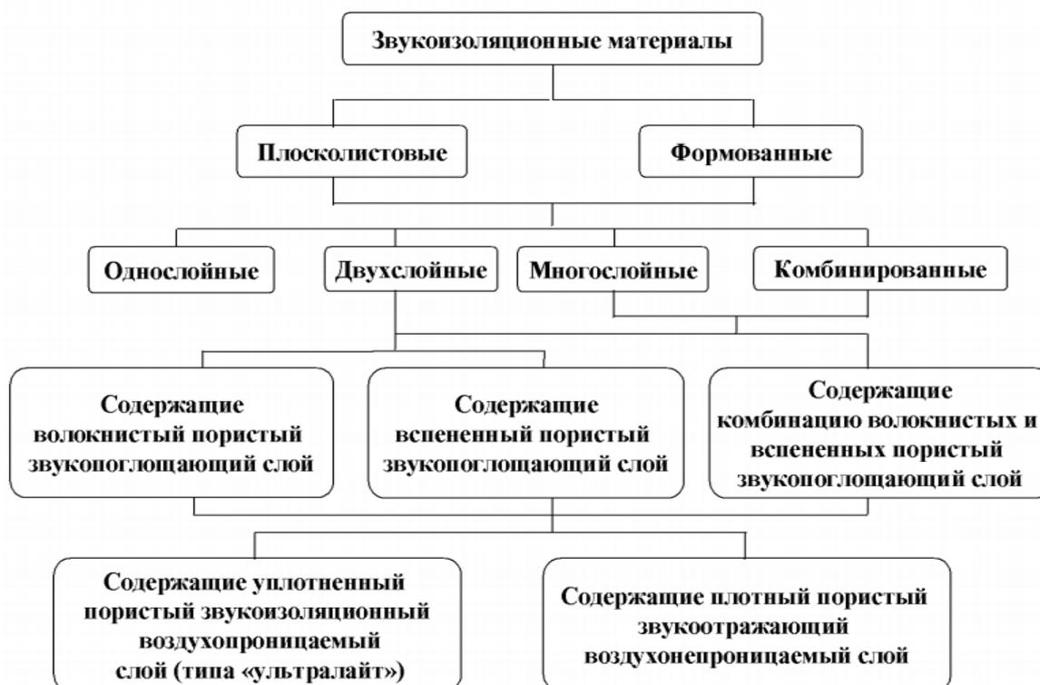
Рисунок 2 – Классификационная схема звукоизоляционных материалов
