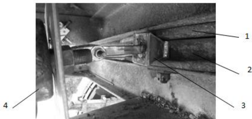
1 – верхнее полукольцо; 2 – нижнее полукольцо; 3 – фиксатор; 4 – пневматическая диафрагма
