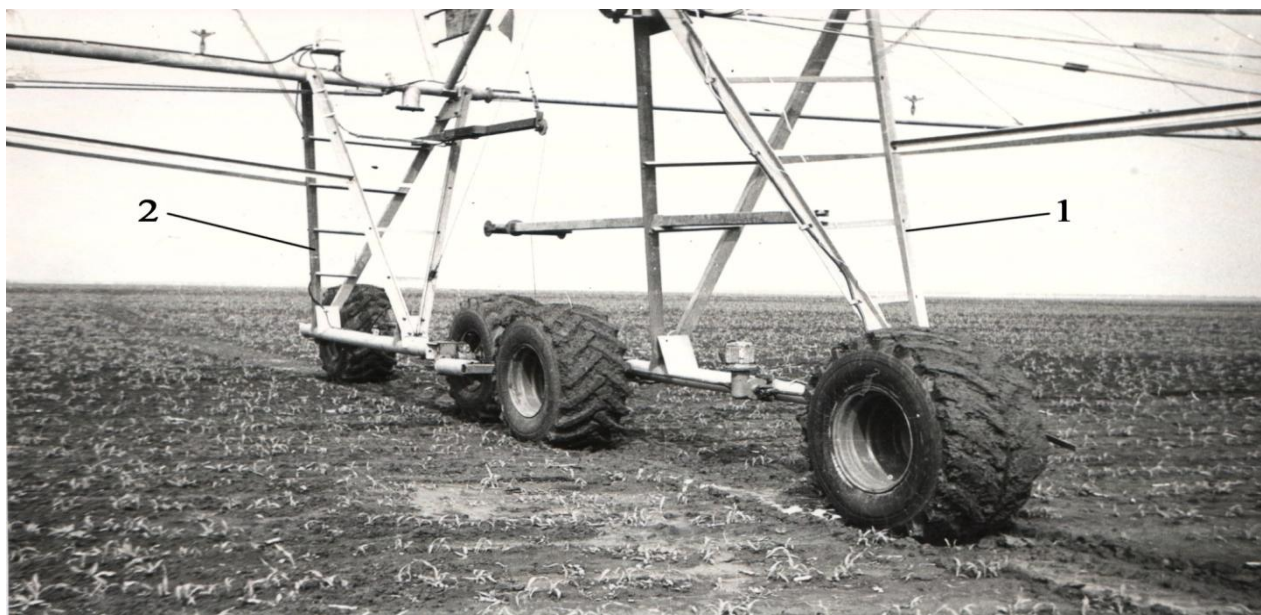
Рисунок 1 – Дождевальная машина «Бригантина»
