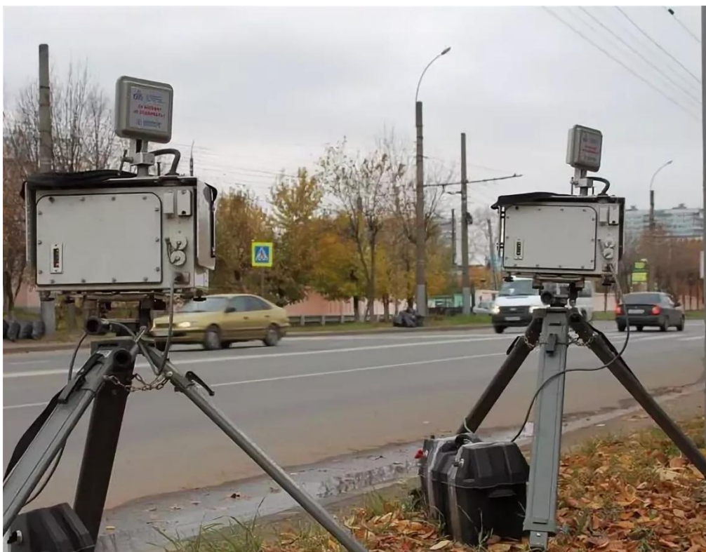
Рисунок 2 – Фиксация интенсивности транспортного потока с помощью переносных детекторов
