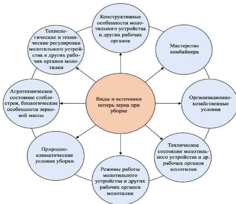
Рисунок 1 - Причины и факторы, обуславливающие количество потерь и механических повреждений зерна при уборке
