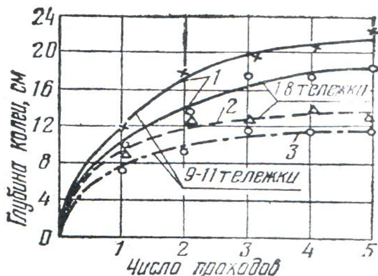
Рисунок 3 – Зависимость глубины колеи машины от числа проходов
