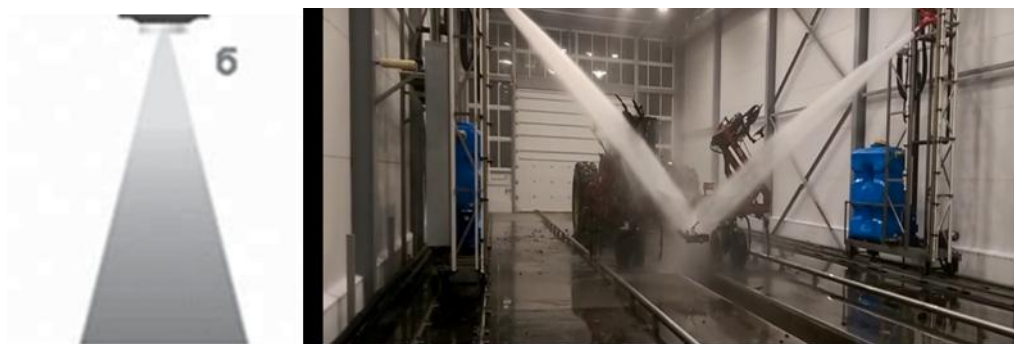
Рисунок 1 – Водоструйная очистка сельхозтехники
