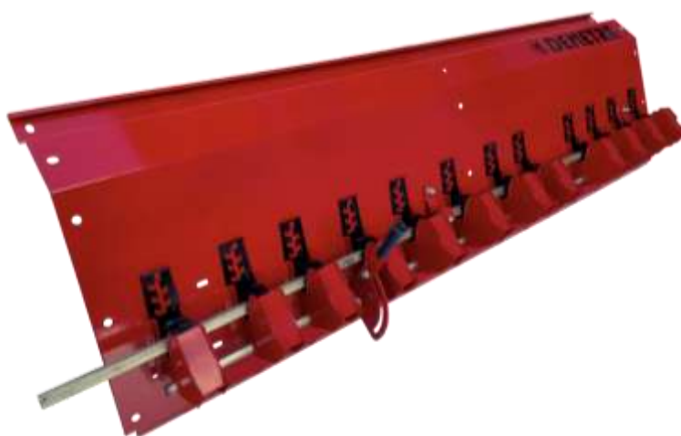
Рисунок 2 – Общий вид секции катушечного туковысевающего аппарата
