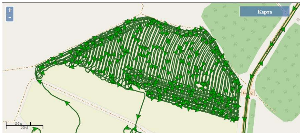
Рисунок 5 – Объективный контроль качества работы машинно-тракторного агрегата, оснащенного автопилотом, с применением терминала спутникового контроля и мониторинга Navtelecom SMART S-2435 и программного обеспечения Fort Monitor, подложка Open Street Maps, дата: 17 апреля 2021 года
