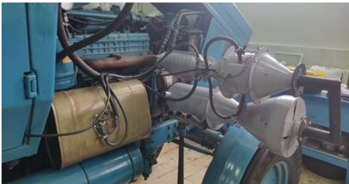
Рисунок 3 – Макетный образец автоматизированного устройства для очистки отработавших газов с ионизирующим контуром на лабораторных испытаниях
