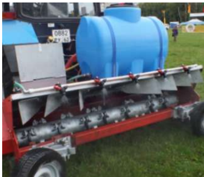
Рисунок 2 – Вынос форсуночной рампы из зоны измельчения по патенту на ПМ 179685
