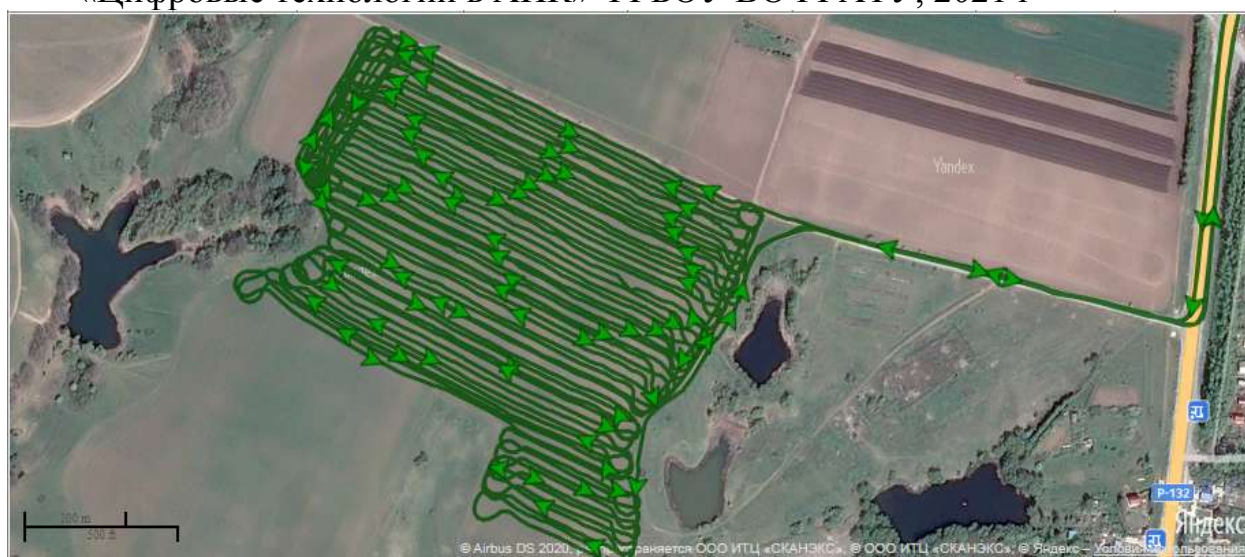
Рисунок 4 – Объективный контроль качества работы машинно-тракторного агрегата, оснащенного автопилотом, с применением терминала спутникового контроля и мониторинга Navtelecom SMART S-2435 и программного обеспечения Fort Monitor, подложка Яндекс Карты (аэрофотосъемка), дата: 16 апреля 2021 года
