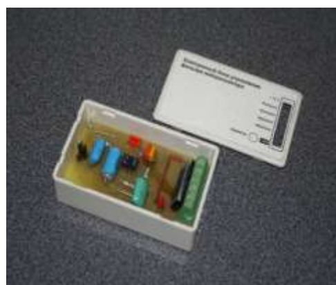
Рисунок 4 – Ионизирующий контур, установленный внутри аэрозольной камеры нейтрализатора (слева) и электронный блок для автоматического управления режимом работы устройства (справа)
