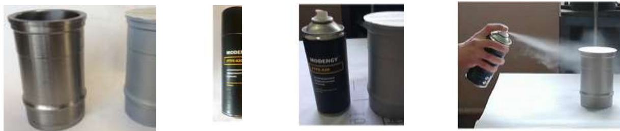
Рисунок 5 – Нанесение электроизолирующего покрытия из баллона под давлением
