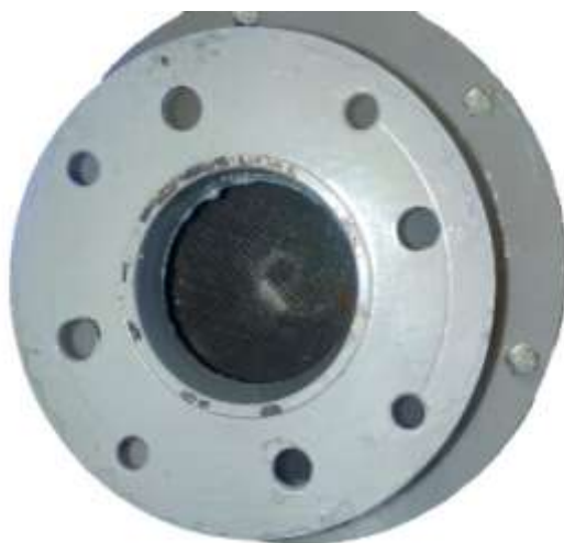
Рисунок 4 – Ионизирующий контур, установленный внутри аэрозольной камеры нейтрализатора (слева) и электронный блок для автоматического управления режимом работы устройства (справа)
