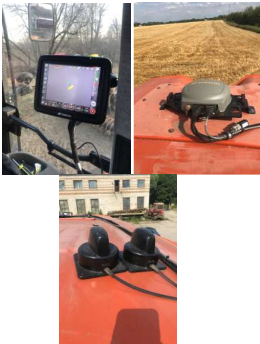
Рисунок 2 – Автопилот, установленный на университетском тракторе Terrion в Опытной агротехнологической станции пос.Стенькино: слева – курсоуказатель в кабине, по центру и справа – антенны спутниковой навигации, системы дифференциальной коррекции спутниковых сигналов и модема для приема заданий через сеть Интернет
