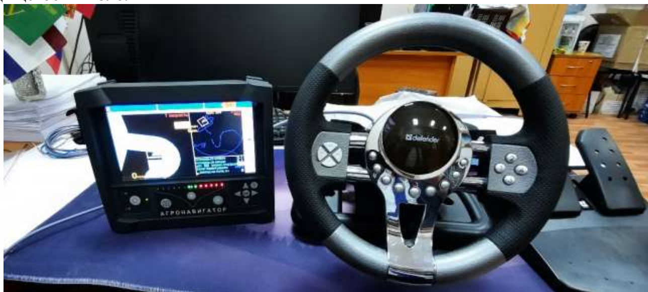
Рисунок 3 – Автопилот – тренажер для подготовки студентов СПО, бакалавров, магистров и аспирантов агроинженерного профиля Центр «Цифровые технологии в АПК» ФГБОУ ВО РГАТУ, 2021 г
