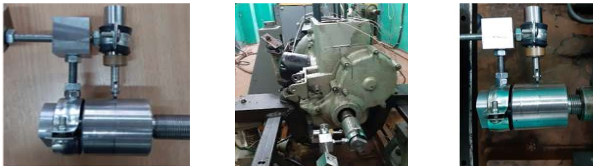
Рисунок 2 – Снятие электрических показаний с помощью токосъемного устройства (Патент № 210271, Заявка 2021135580, 05.04.2022)
