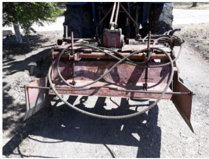
Рисунок 2– Грядоделатель навесной с фрезой для нарезки гряд размером 1,4 м
