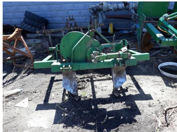
Рисунок 4–Активная выкопочная скоба для высадки саженцев для трактора класса 9кН
