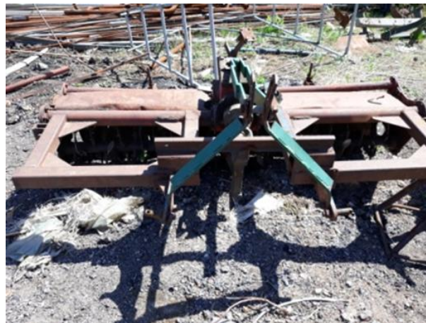
Рисунок 6– Вертикальные фрезы для обработки почвы
