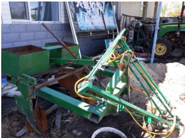
Рисунок 5–Посадочный агрегат для саженцев с системой полива
