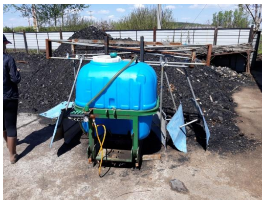
Рисунок 7–Опрыскиватель для обработки саженцев гербицидами и пестицидами с навесным оборудованием китайского производства
