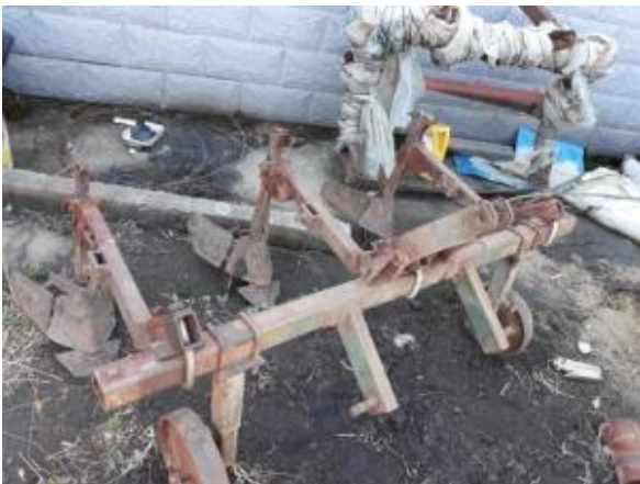
Рисунок 3–Культиватор-окучник для междурядной обработки лесных насаждений
