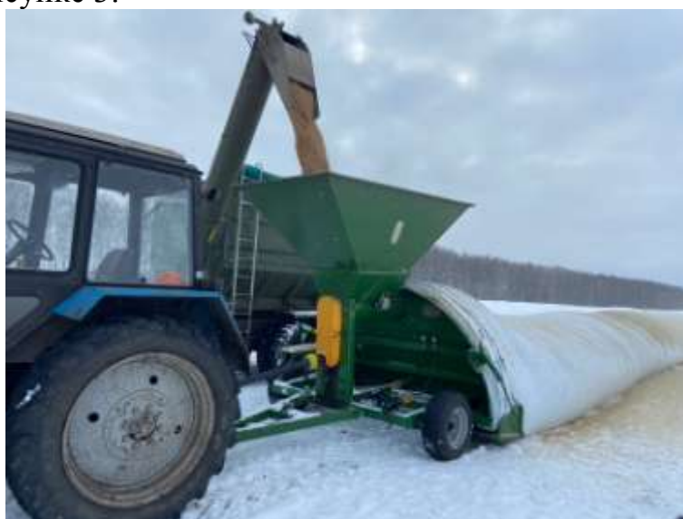
Рисунок 3 – процесс загрузки полиэтиленового рукава зерном
