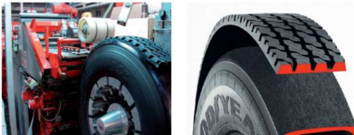
Рисунок 2 – Повреждение и восстановление покрытия шины
