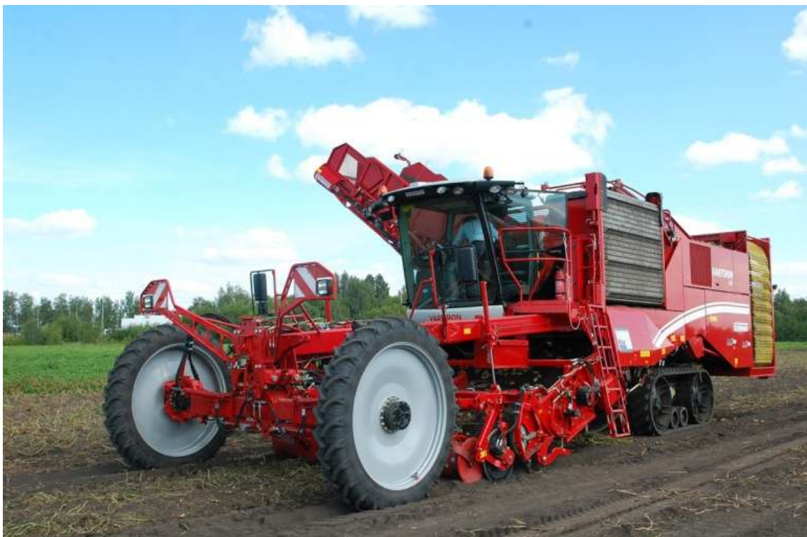
Рисунок 3 – Самоходный картофелеуборочный комбайн фирмы Grimme
