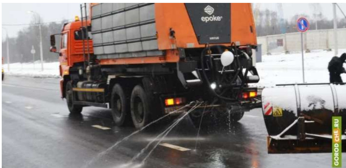
Рисунок 2 – Обработка дорожного покрытия реагентом
