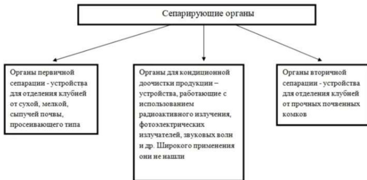
Рисунок 1 – Схема сепарирующих органов
