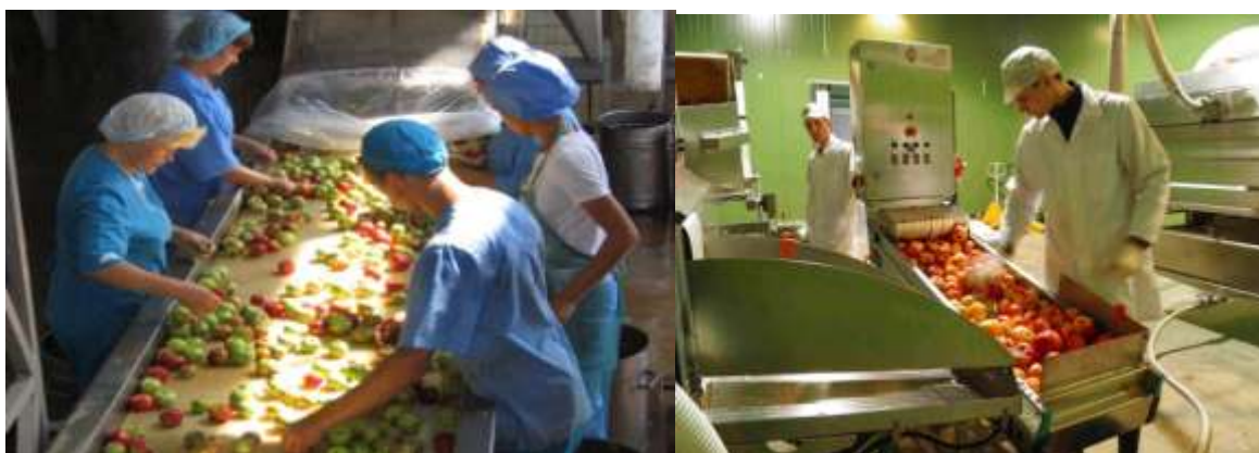
Рисунок 3 – Сортировка и калибровка плодоовощной продукции ручным и механическим способом
