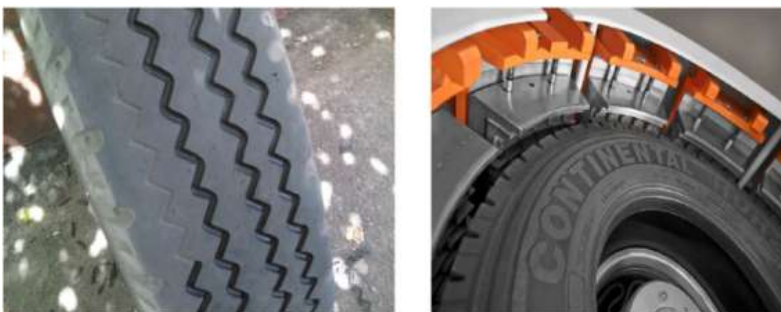
Рисунок 1 – Повреждение и восстановление покрытия шины
