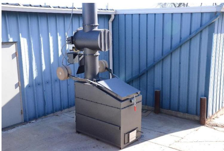
Рисунок – Инсинезатор
