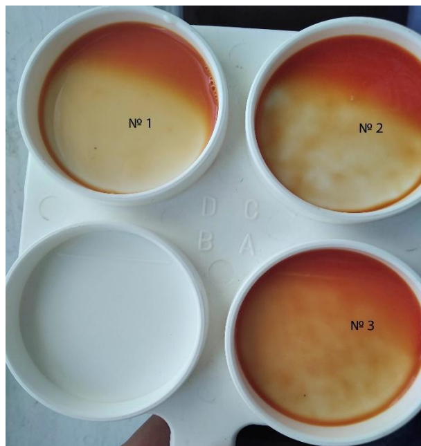
Рисунок 2 – Качественная реакция при определении количества соматических клеток в молоке
