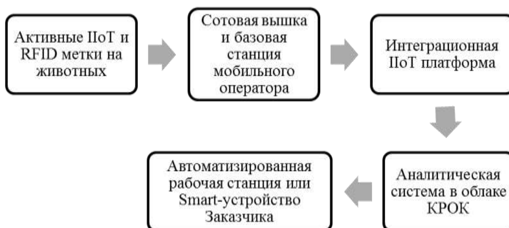
Рисунок 4 – Принцип работы системы мониторинга стада животных
