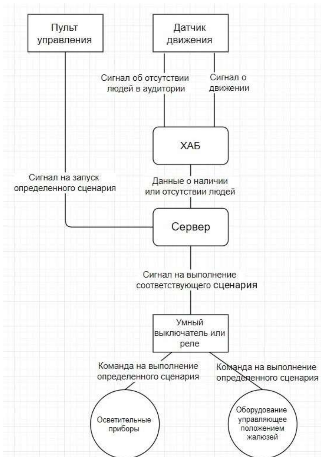
Рисунок 2 – Схема работы осветительных приборов в системе «Умное освещение»
