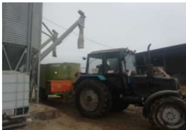
Рисунок 2 – Наполнение кормораздатчика СРК «Хозяин»
