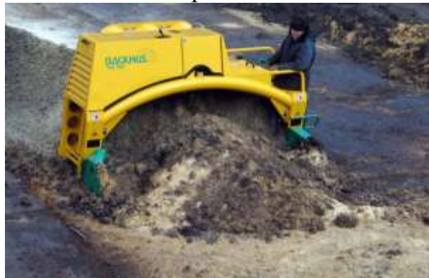
Рисунок 4 – Ворошитель буртов BASKHUS, дозревание в течение 2-х недель для ускоренного компостирования
