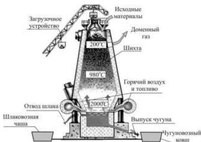
Рисунок 1 – Схема доменной печи
