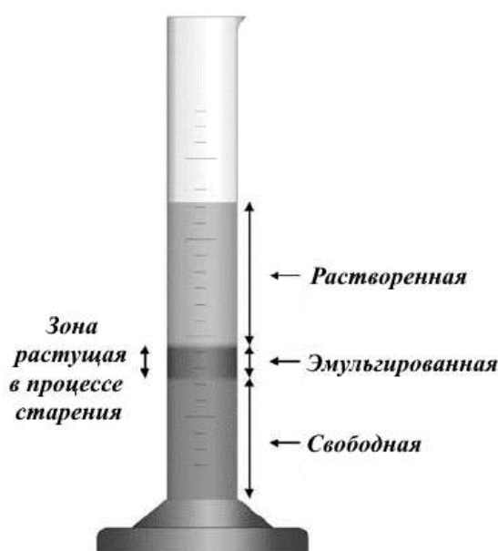
Рисунок 1 – Три состояния воды в моторном масле
