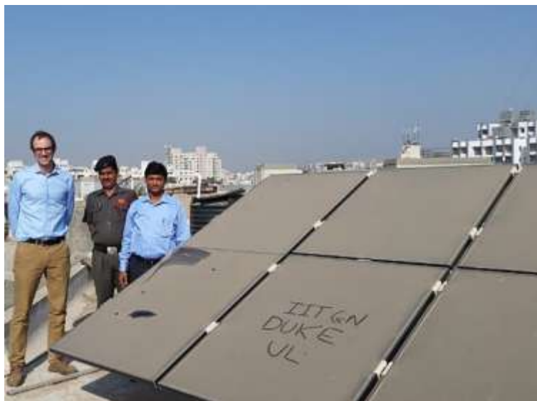
Рисунок 1 – Запыленные солнечные панели в Индии, не очищавшиеся в течение месяца
