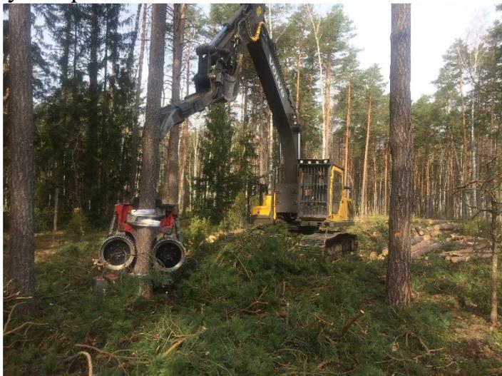
Рисунок 2 – Валочная машина на чересполосно-постепенной рубке.
