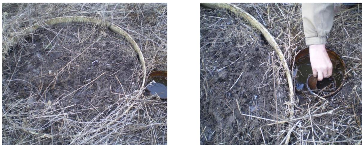
Рисунок - Общий вид лизиметра и откачка инфильтрационных (лизиметрических) вод из кармана перед проведением научно-исследовательской работы
