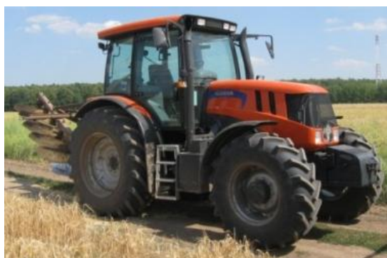
Рисунок 1 – Опытный пахотный агрегат АТМ 3180 «Terrion» + ПЛН-5-35
