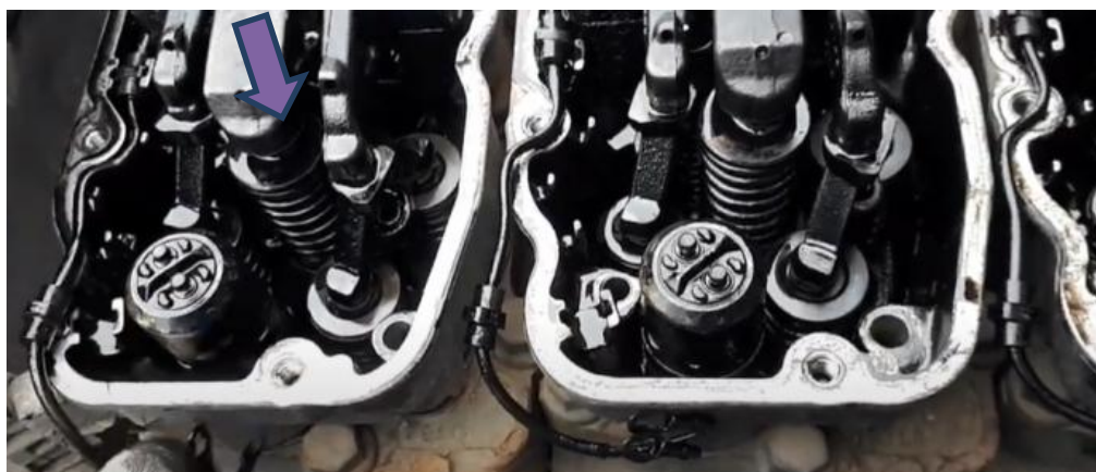
Рисунок 4 – Подача напряжение на форсунку
