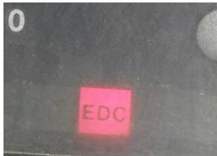
Рисунок 2 – Неисправность топливной системы
