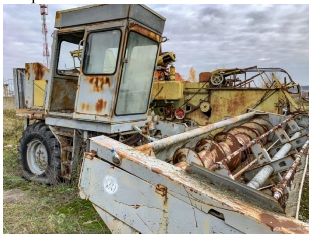
Рисунок 1 Результат воздействия коррозии на сельскохозяйственную технику
