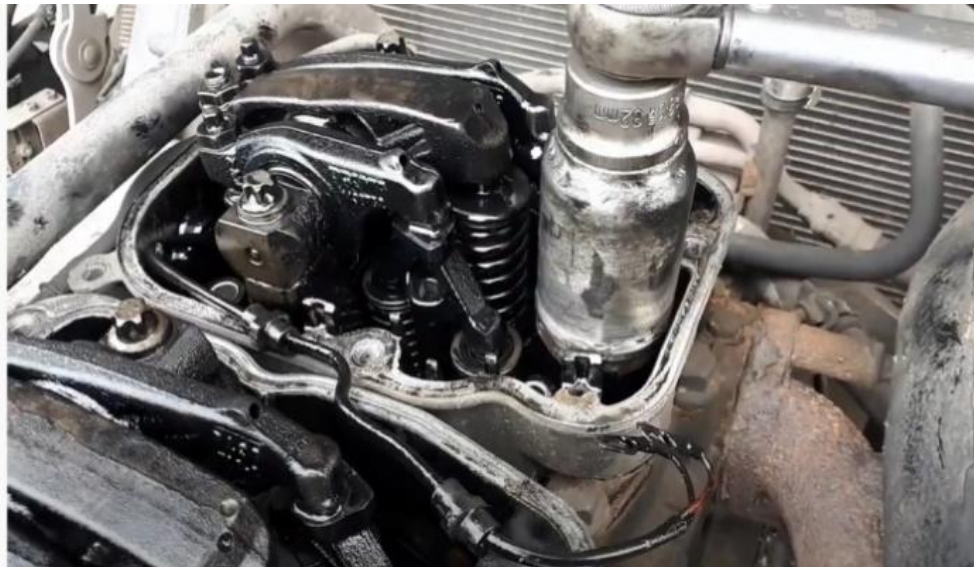
Рисунок 5 – Затяжка электромагнитных клапанов
