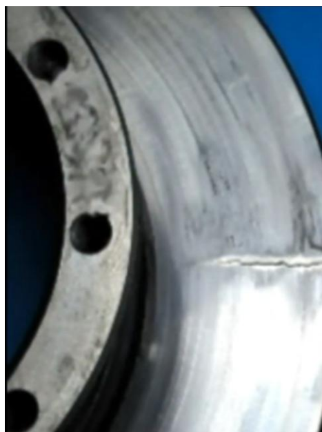
Рисунок 2 – Трещины на тормозном диске
