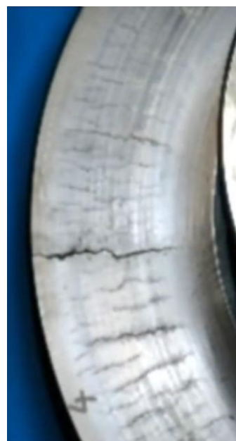
Рисунок 2 – Трещины на тормозном диске
