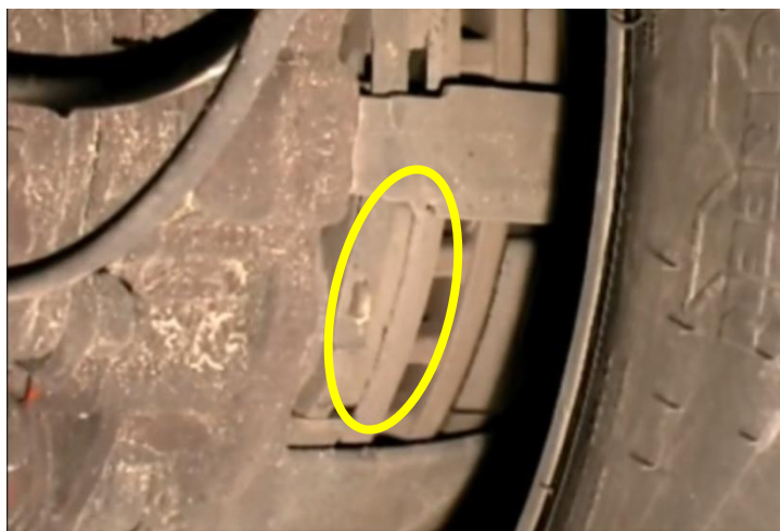
Рисунок 1 – Рабочий зазор между диском и колодкой
