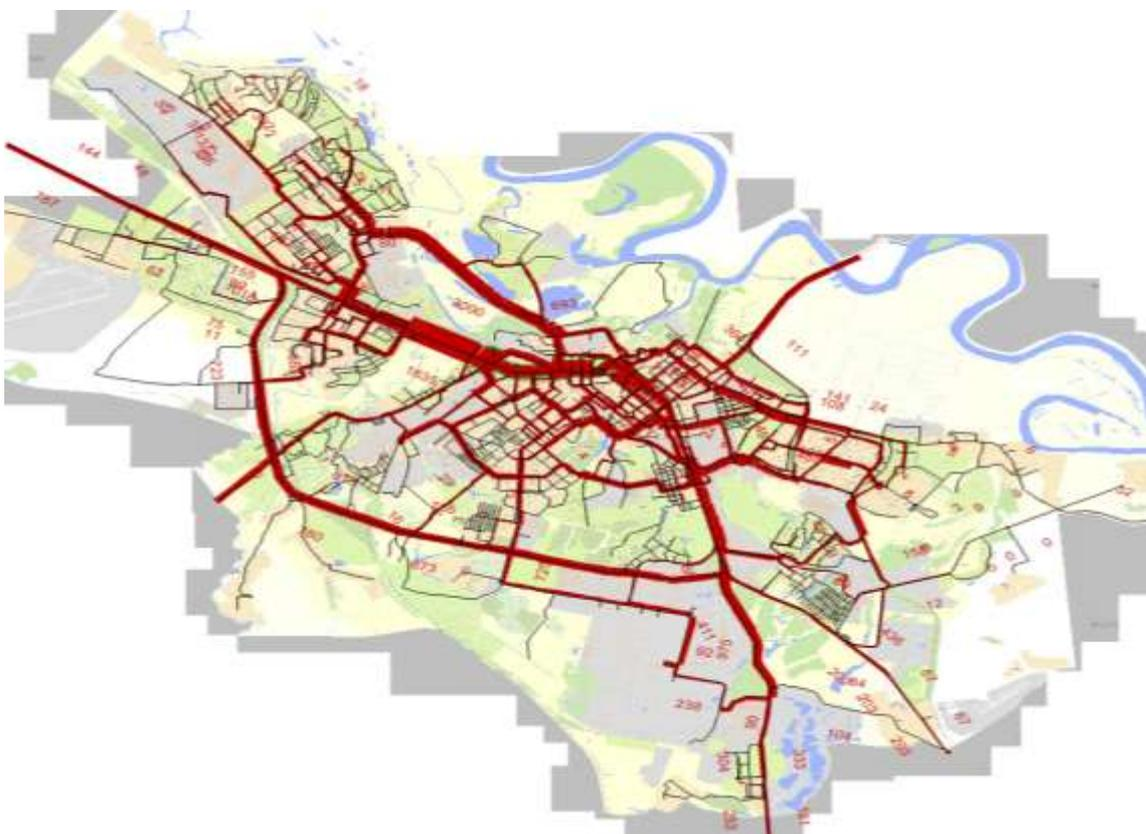
Рисунок 2 – Картосхема расчетной интенсивности движения транспорта
