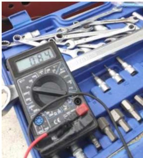
Рисунок 4 – Напряжение датчика с установленной новой тормозной колодкой
