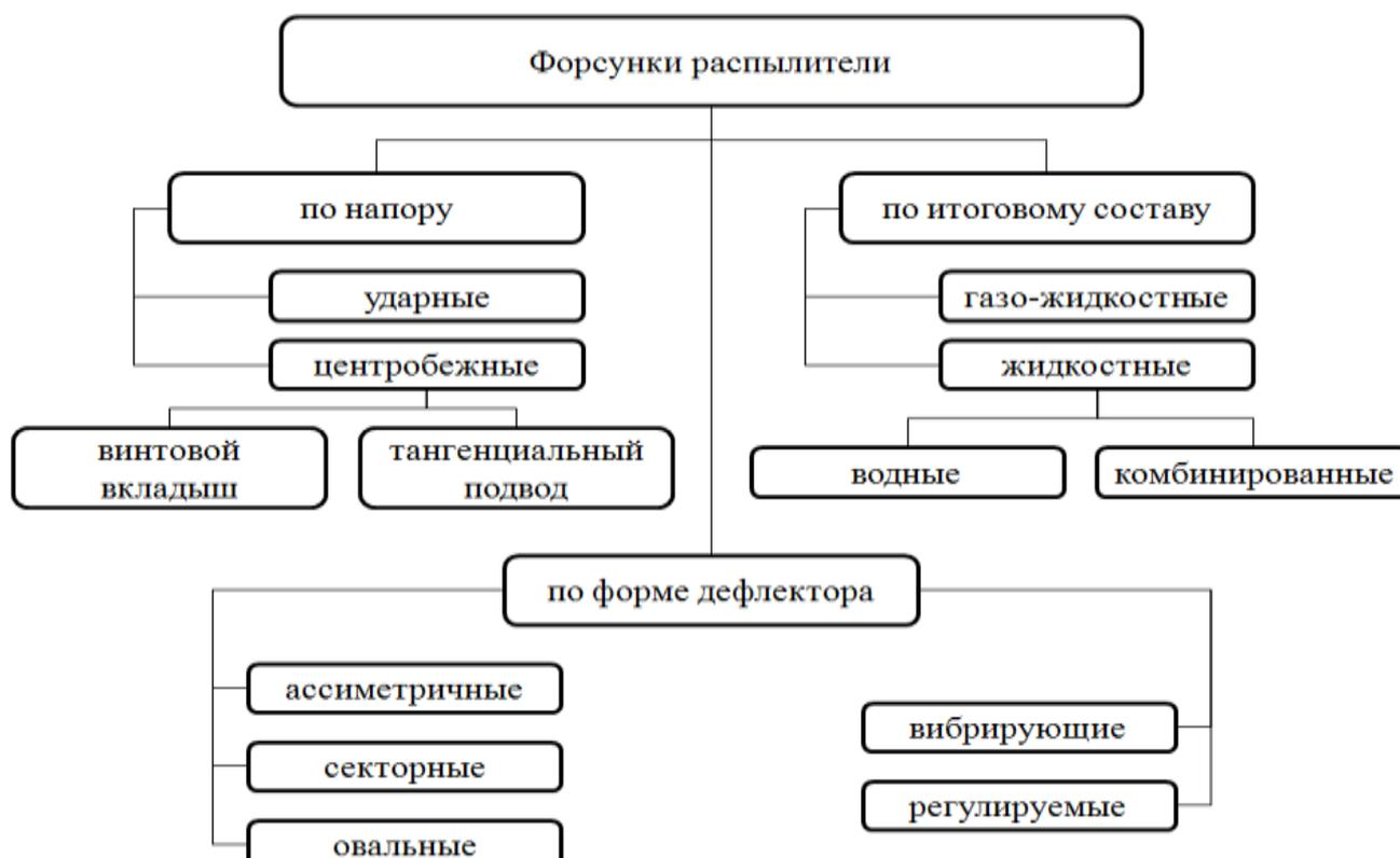
Рисунок 1 – Классификация форсунок распылителей
