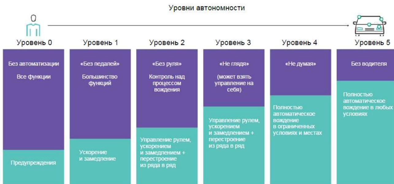
Рисунок 2 – Уровни автономности согласно SAE
