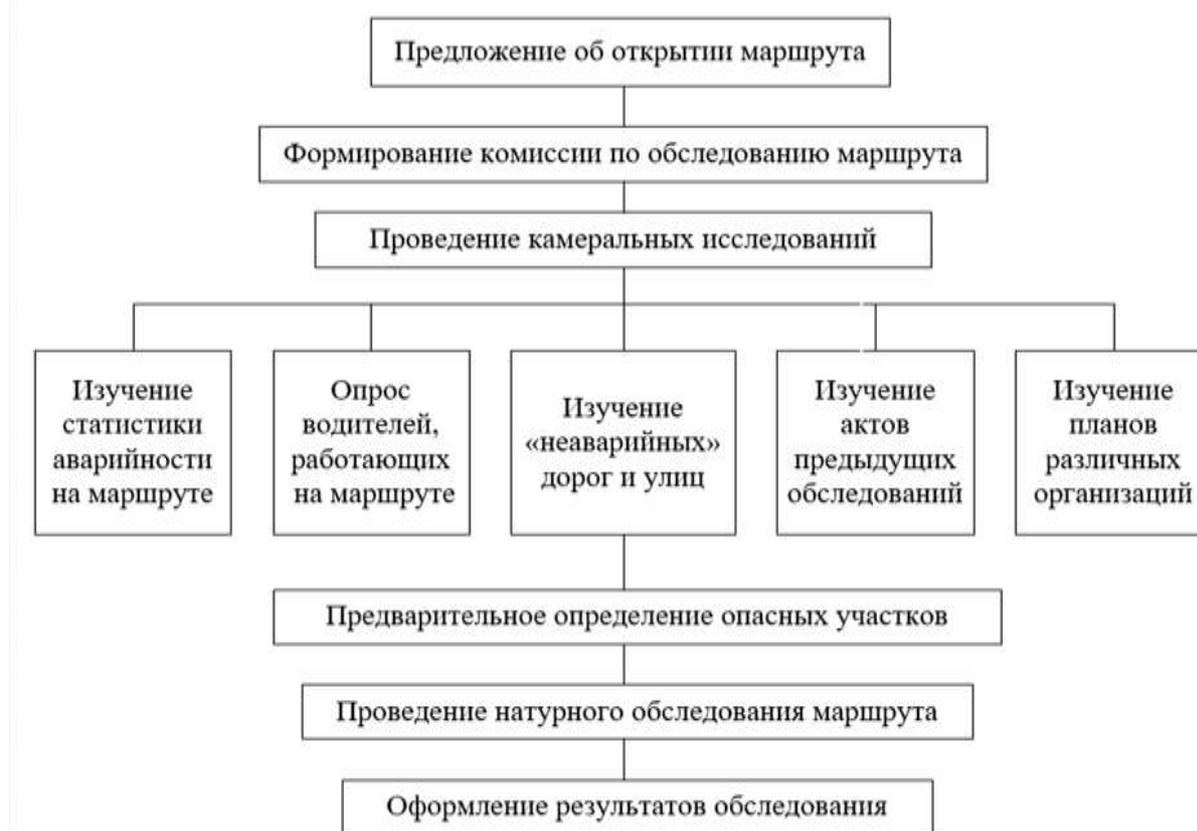
Рисунок 1 – Схема основных этапов обследования маршрутов
