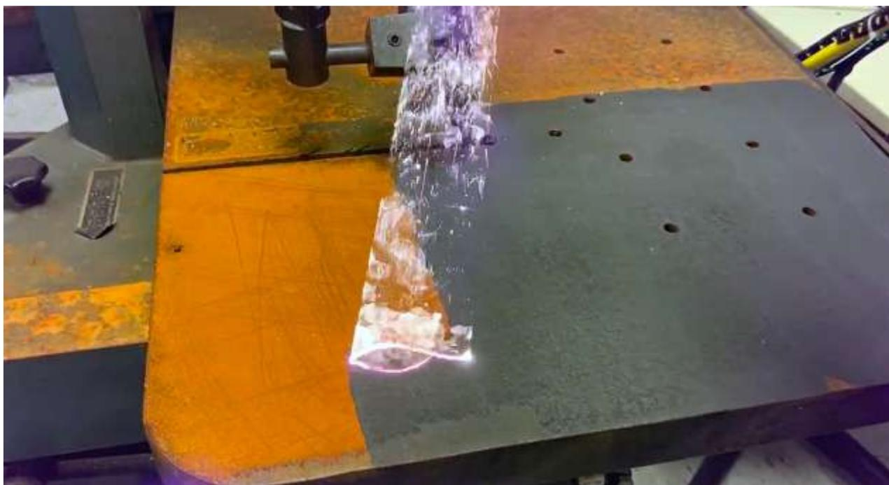
Рисунок 3 – Пример удаления ржавчины с поверхности
