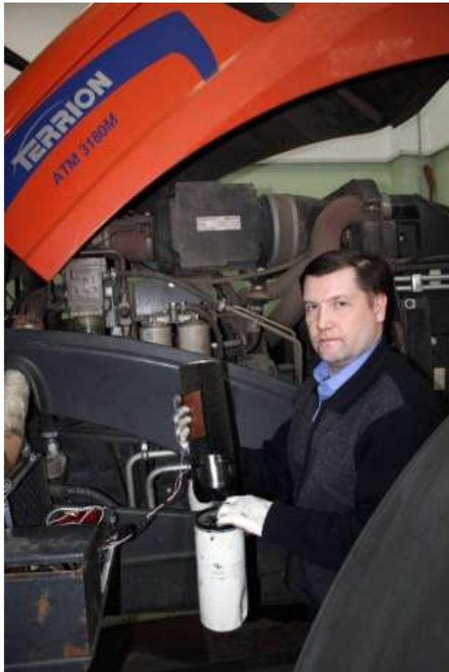
Рисунок 2 – общий вид диагностической системы технического состояния масляной системы на основе фильтрующего элемента
