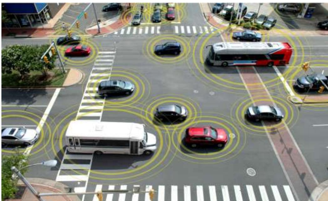
Рисунок 1 – Пример системы обмена информацией между автомобилями с помощью системы V2V
