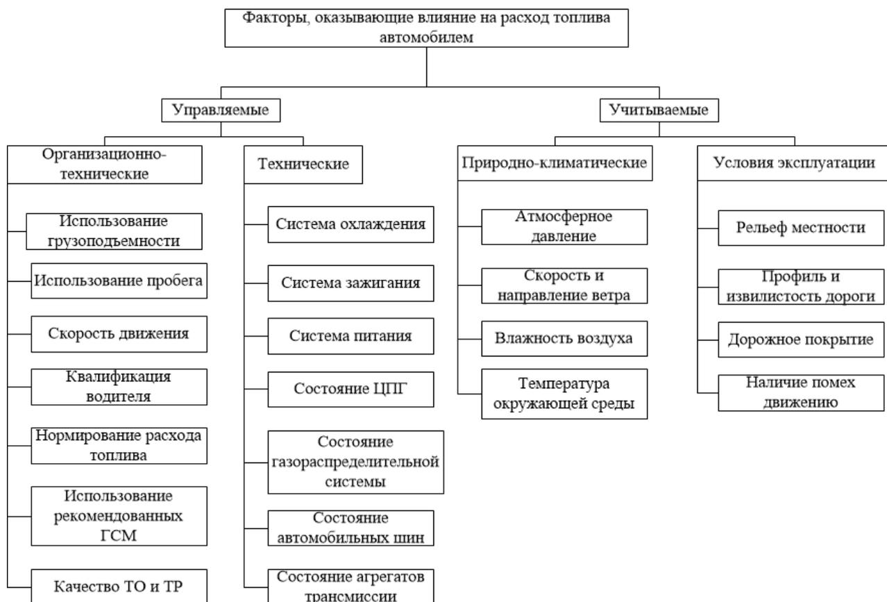
Рисунок 1 – Классификация факторов расхода топлива автомобиля
