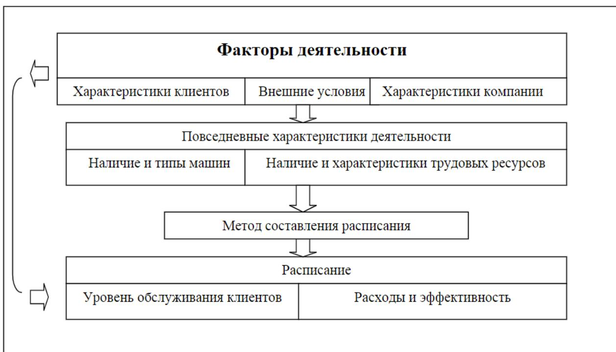
Рисунок 1 – Факторы, влияющие на порядок составления расписания грузоперевозок
