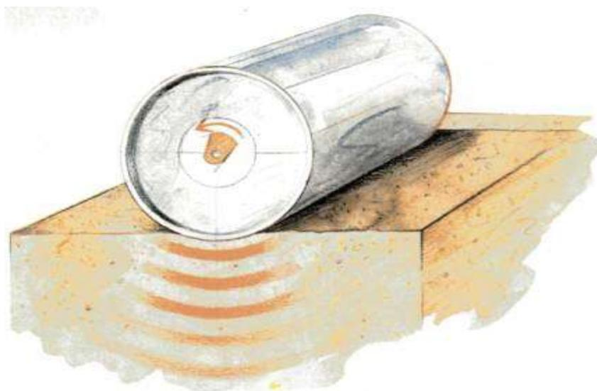
Рисунок 5 – Давление при вибрационном уплотнении
