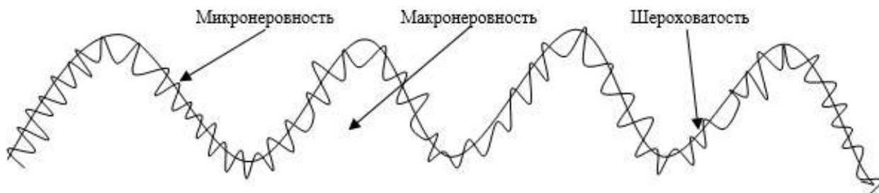
Рисунок 1 – Неровности поверхности дороги
