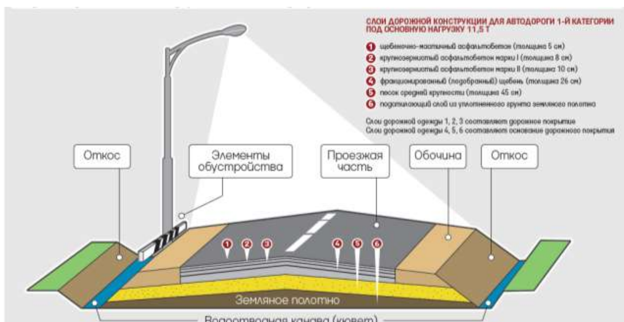
Рисунок 1 – Примерная конструкция автомобильной дороги
