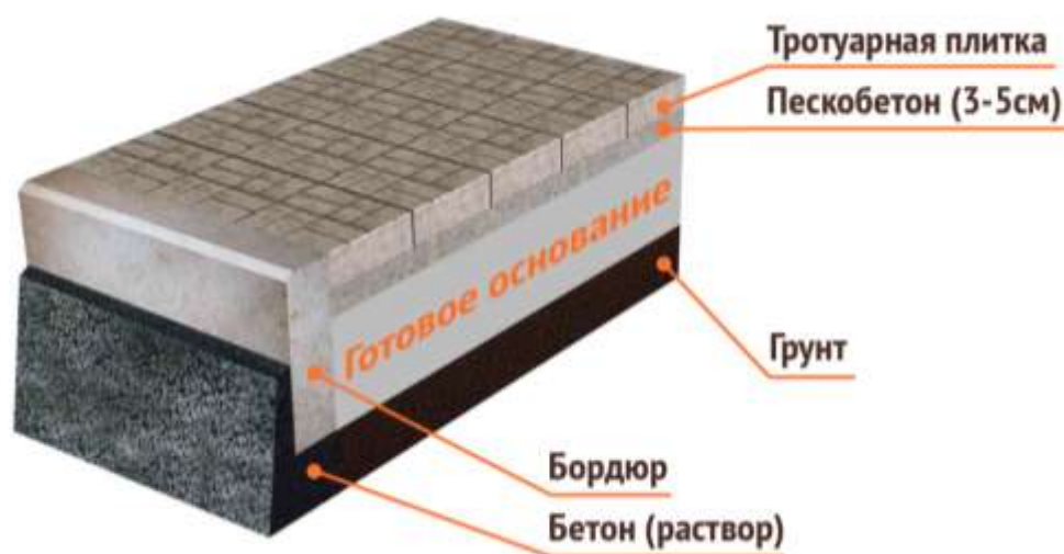
Рисунок 1 – Укладка тротуарной плитки с частичной подготовкой основания без материалов
