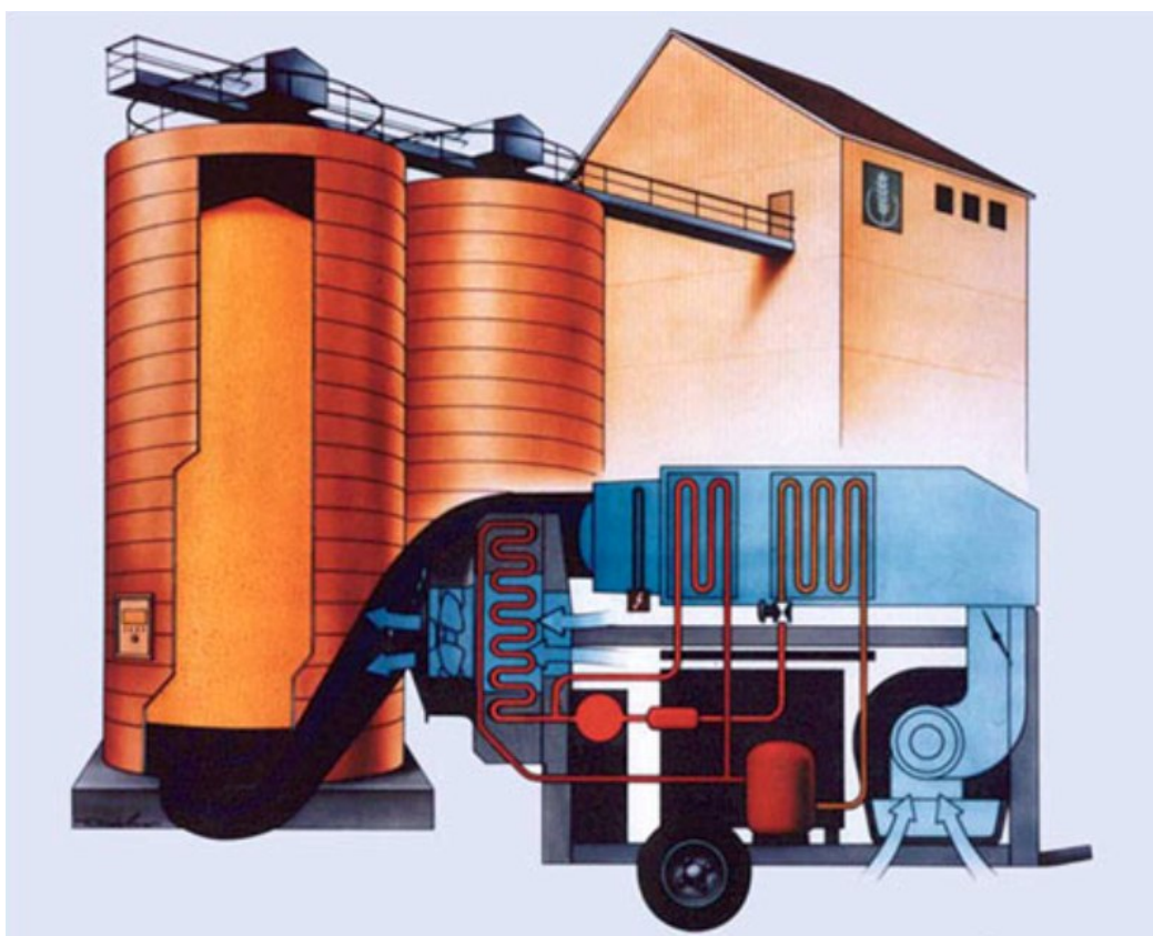
Рисунок 1 – Установка для производства углекислого газа
