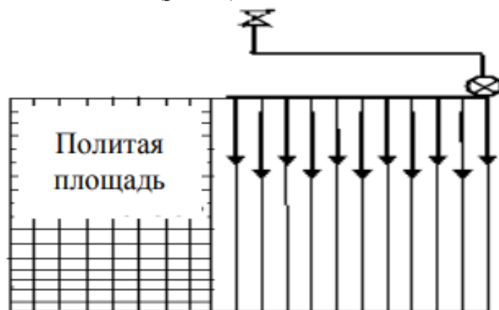
Рисунок 1 – Схема расстановки и перемещения шлангового поливного устройства АШУ-32
