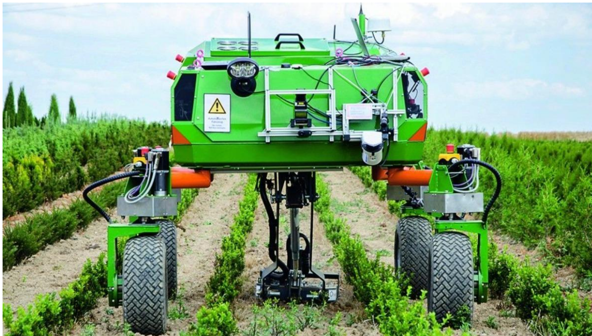
Рисунок 1 – Робот для удаления сорняков BoniRob
