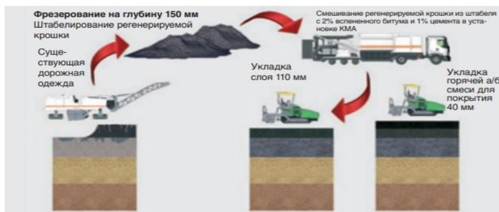
Рисунок 3 – Схема применения ресайклинга на разрушенной дорожной одежде относительно тонкого (150 мм) слоя асфальтобетона
