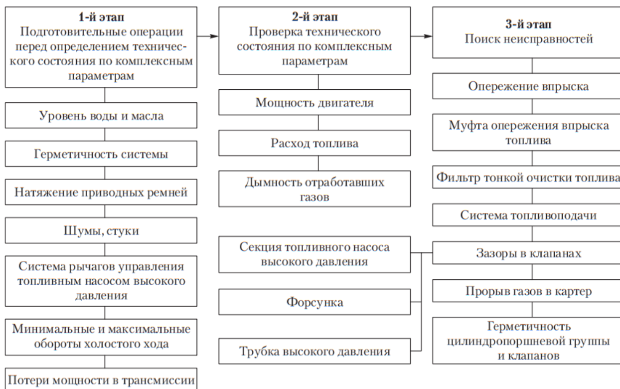
Рисунок 1 – Схема поэлементного диагностирования дизельного двигателя
