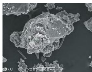
Рисунок 1 – Активация резиновой крошки в битумной смеси
