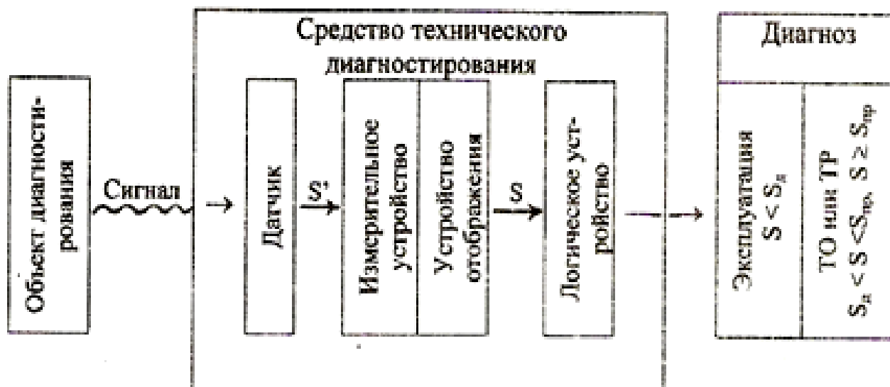
Рисунок 2 – Обобщенная схема встроенных средств диагностирования ТС
