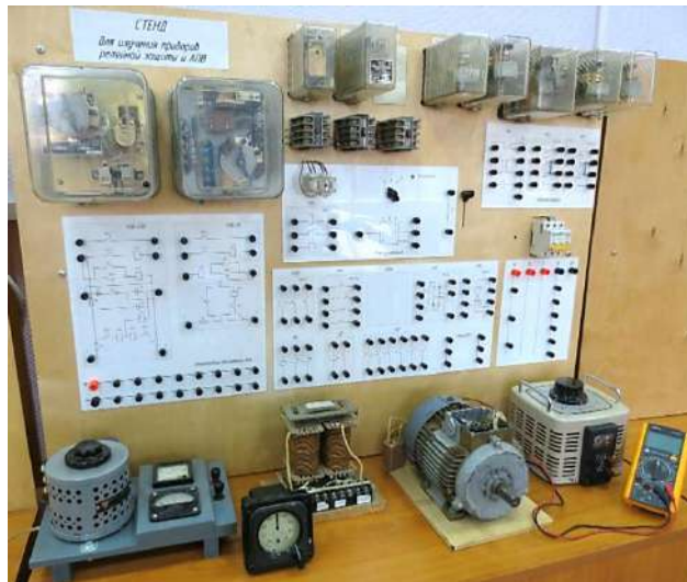
Рисунок 1 – Общий вид стенда для изучения приборов релейной защиты и автоматического повторного включения
