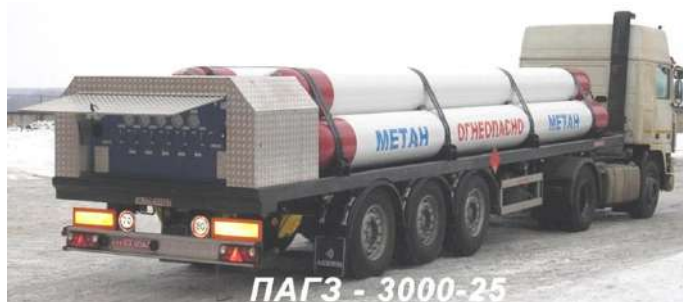
Рисунок 2 – Передвижной автогазозаправщик пассивного типа
