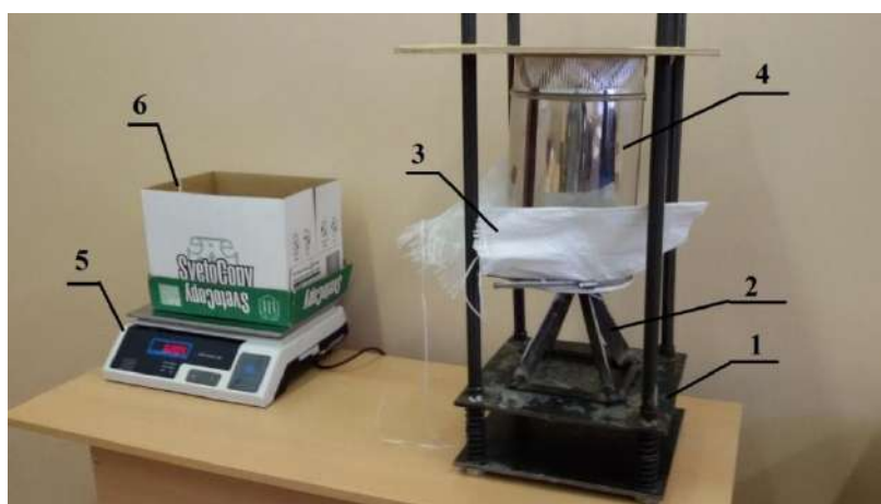
1 – станина; 2 – пирамидальный нож; 3 – полотно мягкого контейнера типа «Биг-Бэг»; 4 – оправка; 5 – весы; 6 – ящик с песком.
