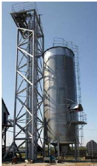
Рисунок 1 – Зерносушилка шахтного типа Astra
