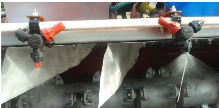
Рисунок 1 – Испытание форсунок с различными углами распыла, 90° слева и 110° справа, при рабочем давлении 0,2 МПа.
