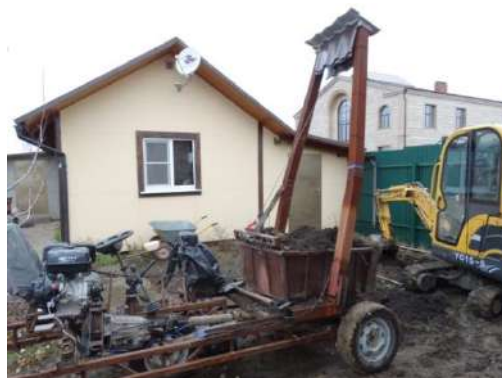
Рисунок 2 – Multifункциональное транспортно-погрузочное средство, работающее в паре с мини-экскаватором
