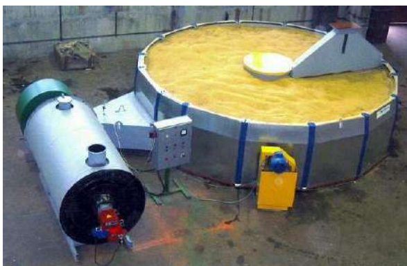
Рисунок 2 – Зерносушилка карусельного типа Agrimec SRL KC
