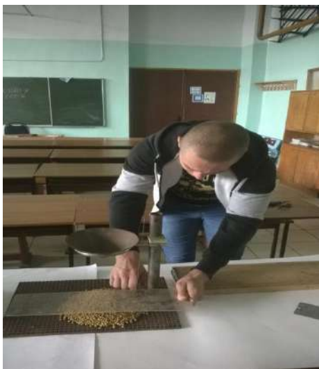
Рисунок 1 – Ситников А.С. определяет коэффициент внутреннего трения и угол естественного откоса семян сои
