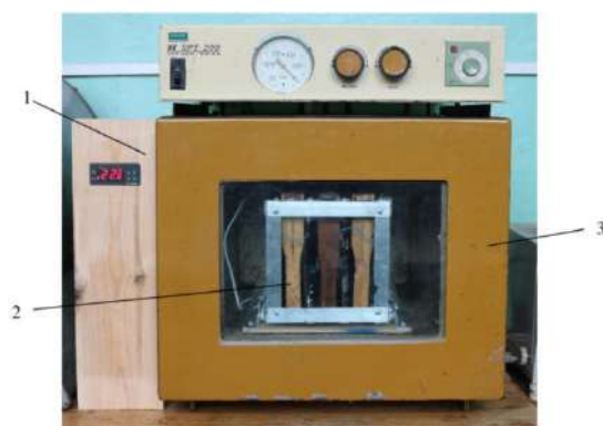
1 – терморегулятор; 2 – вакуумный сушильный шкаф; 3 – универсальная поворотная кассета. Рисунок 1 – Лабораторная установка
