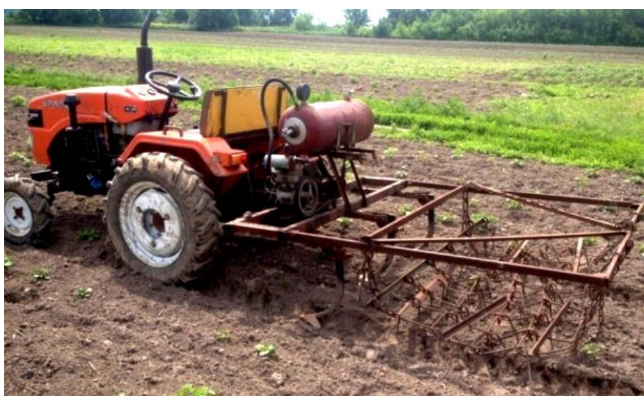
Рисунок 5 – Минитрактор «Уралец 180» с культиватором на «слепой обработке» картофеля от сорняков
