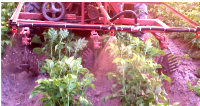
Рисунок 4 – Машинно-тракторный агрегат в составе трактора «Уралец 180» с культиватором КОК-1,8 на культивации с опрыскиванием
