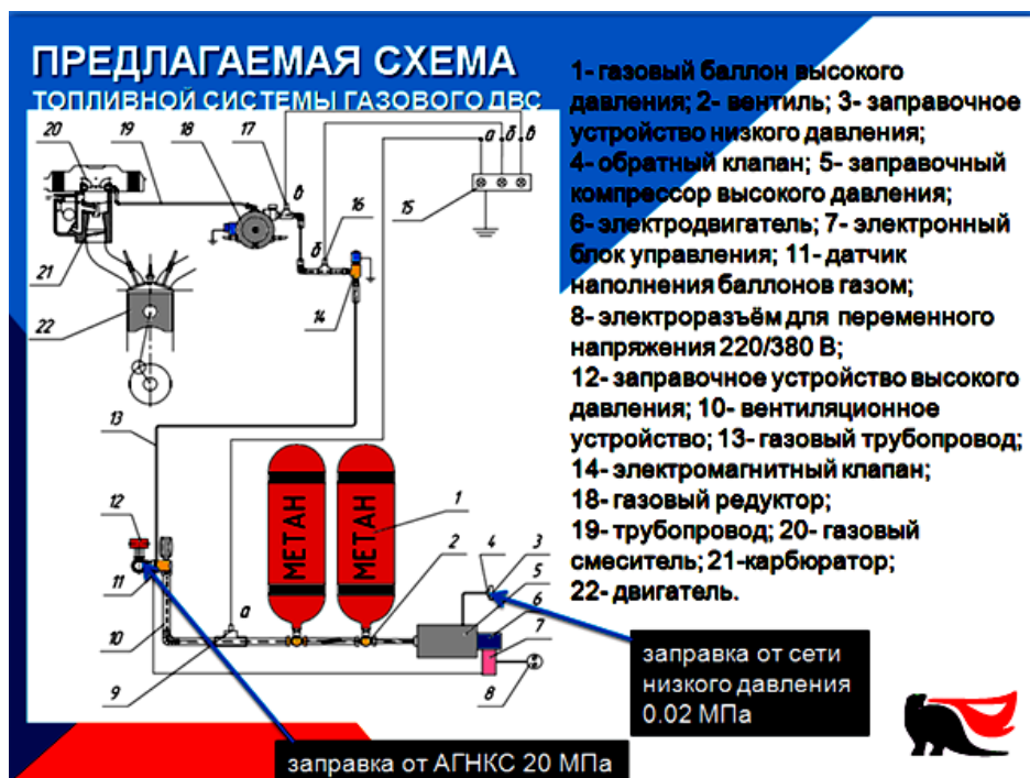
Рисунок 3 - Схема газобаллонного оборудования транспортного средства
